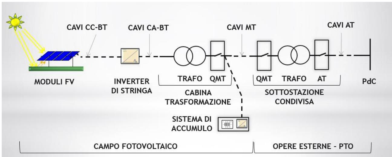
L'impianto FV ha la capacità di generare energia elettrica dai Moduli FV: ogni singolo Modulo FV trasforma l'irraggiamento solare in energia elettrica, generata in forma di corrente continua.
