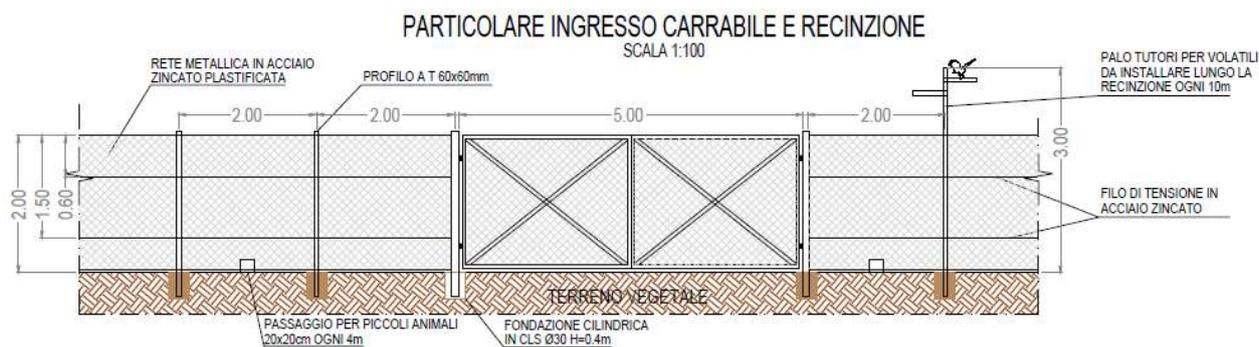
La recinzione perimetrale sarà costituita da una rete metallica in acciaio zincato, plastificata e di colore verde, mantenuta in tensione da fili in acciaio zincato posizionati lungo le estremità superiore e inferiore.
