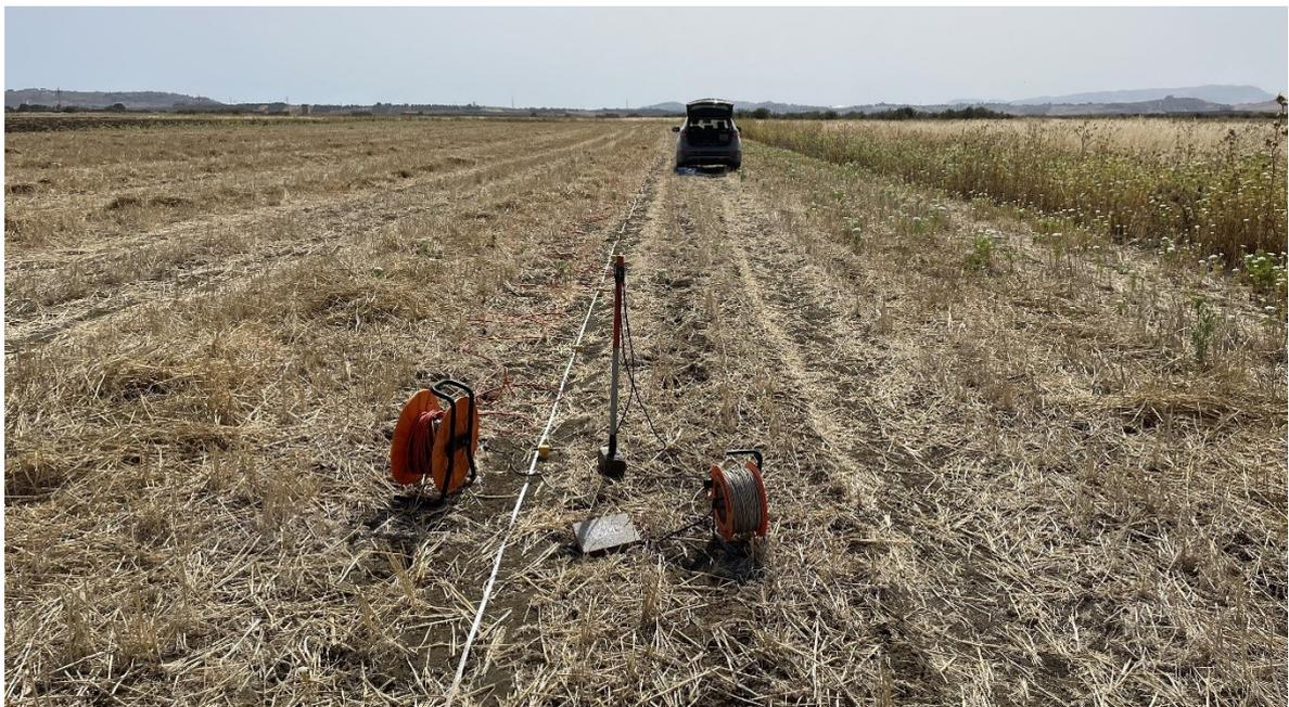
Foto 16 - Stendimento sismico nel sito P8
