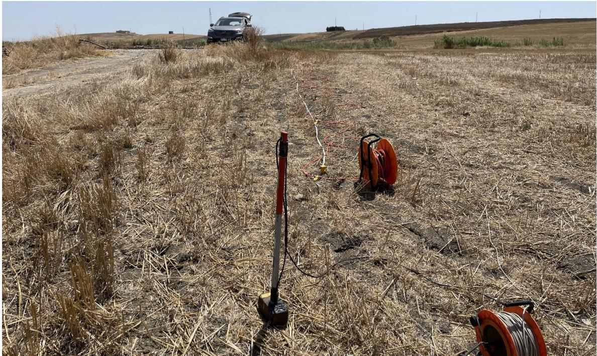
Foto 5 -Stendimento sismico nel sito P3
