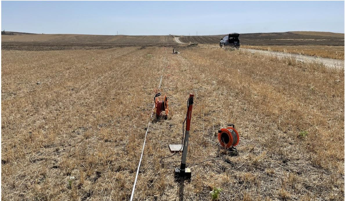
Foto 1 -Stendimento sismico nel sito P1
