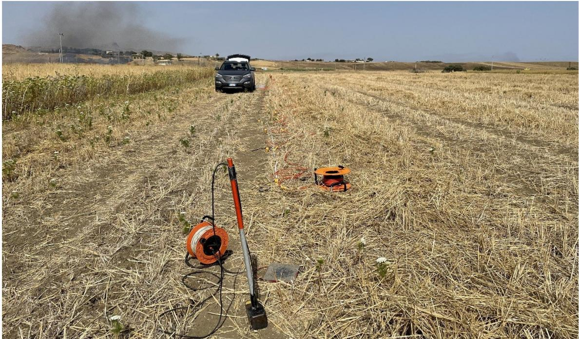
Foto 15 - Stendimento sismico nel sito P8
