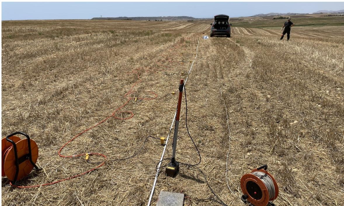
Foto 13 -Stendimento sismico nel sito P7
