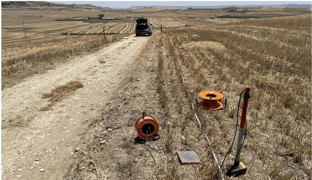
Foto 9 - Stendimento sismico nel sito P5
