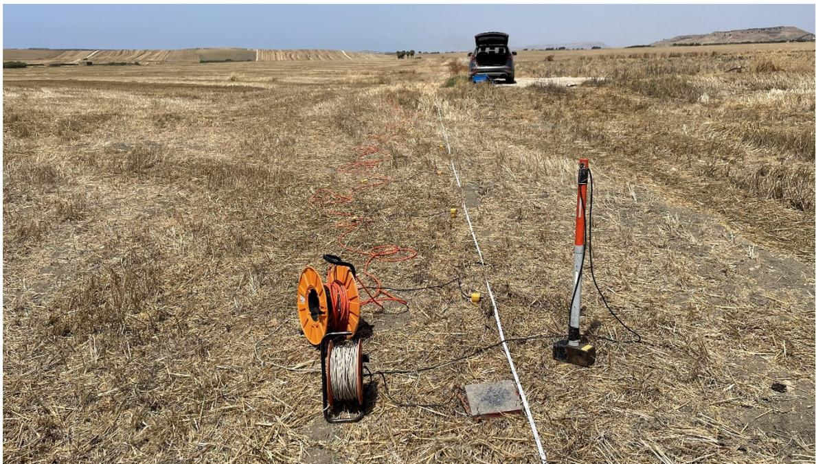
Foto 6 - Stendimento sismico nel sito P3
