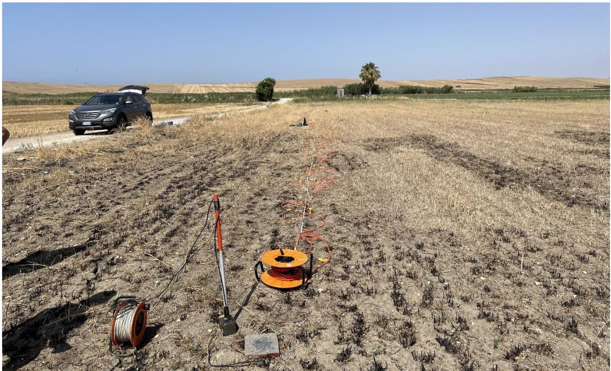
Foto 2 - Stendimento sismico nel sito P1
