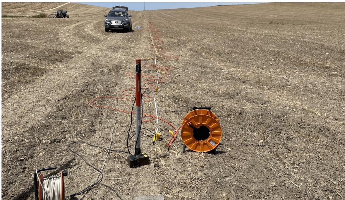
Foto 8 - Stendimento sismico nel sito P4
