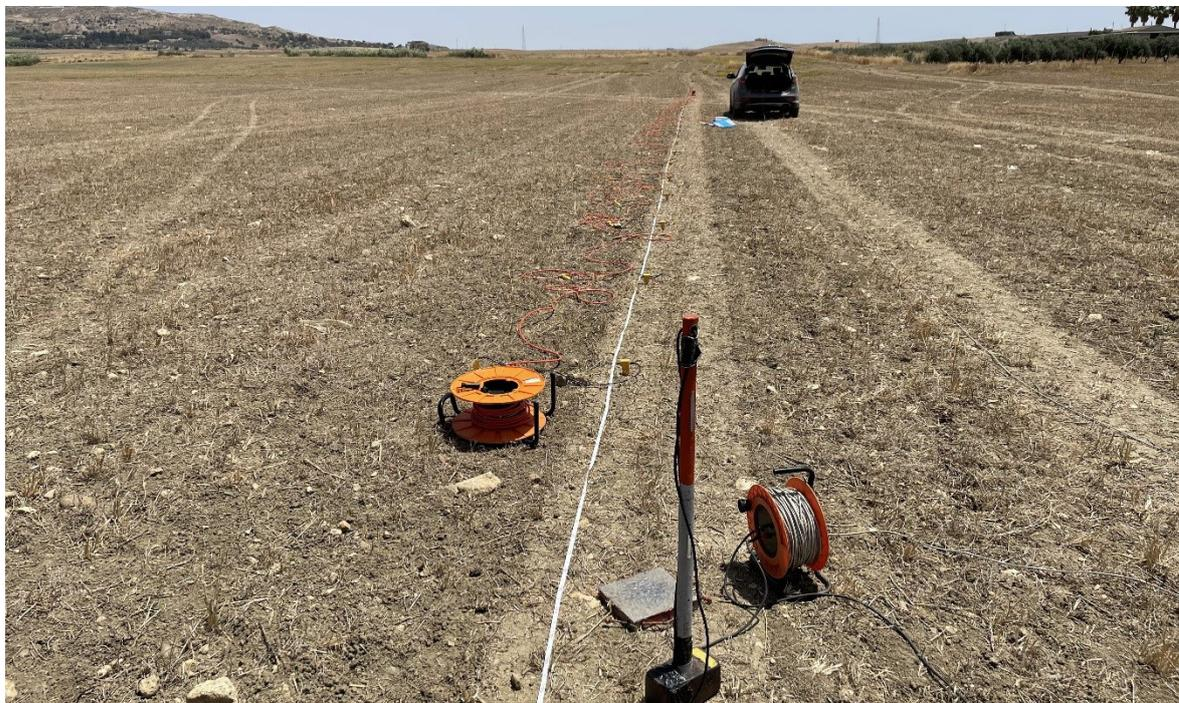
Foto 7 - Stendimento sismico nel sito P4
