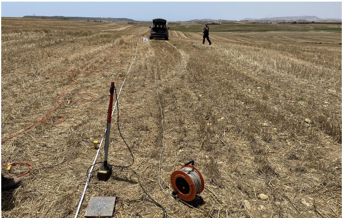
Foto 12 - Stendimento sismico nel sito P6
