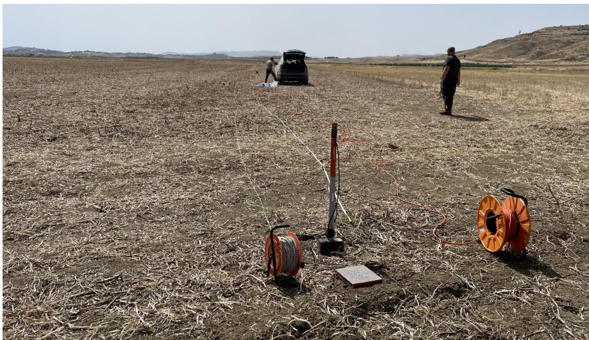
Foto 14 - Stendimento sismico nel sito P7
