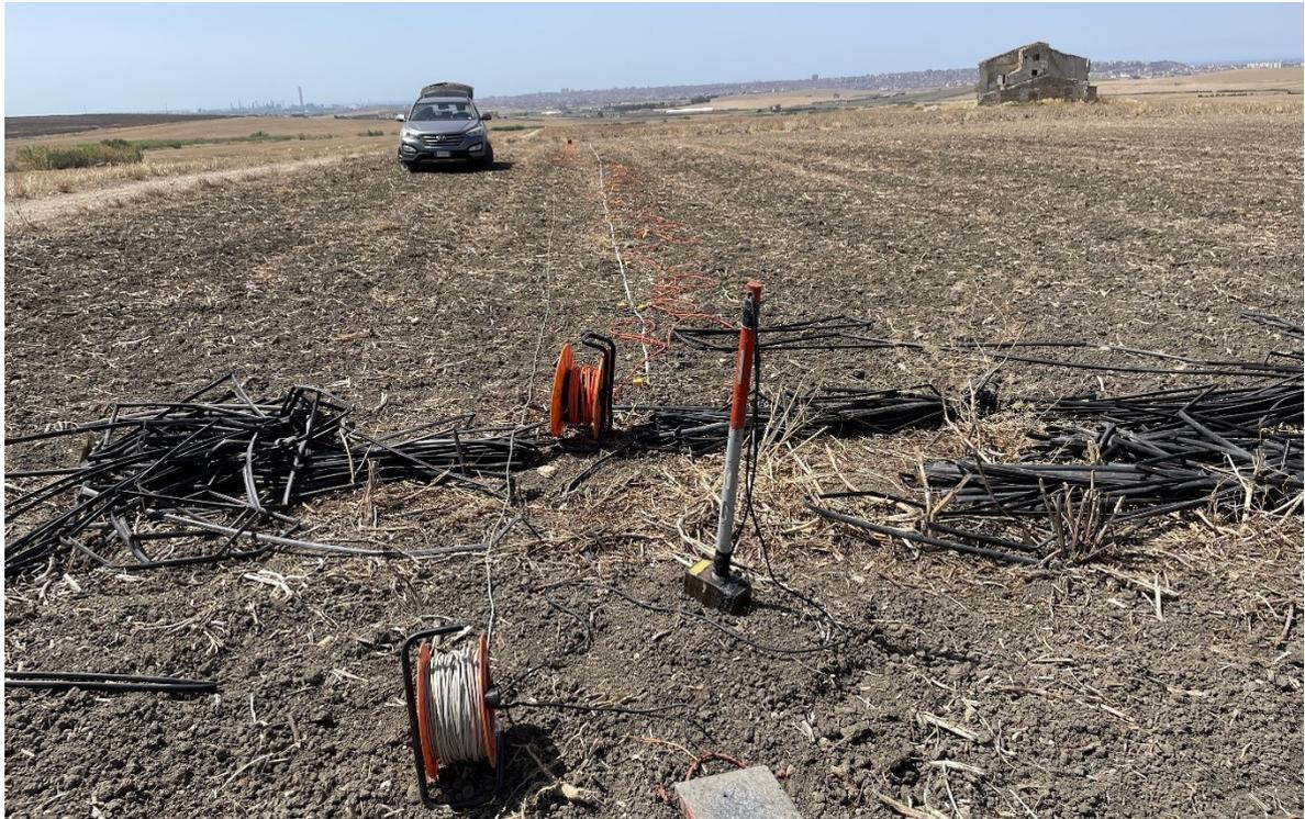
Foto 3 -Stendimento sismico nel sito P2
