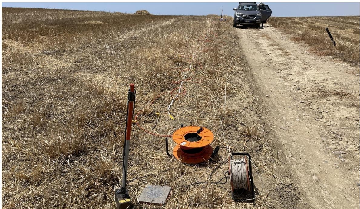
Foto 10 - Stendimento sismico nel sito P5
