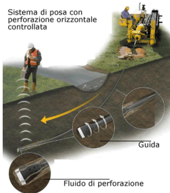
**Figura 11 Sistema di trivellazione orizzontale controllata (T.O.C.).**
