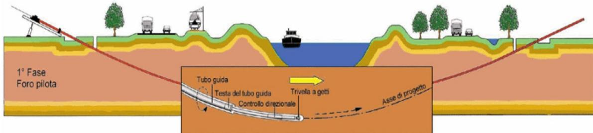
Figura 12 Schema della fase di realizzazione del foro pilota.
