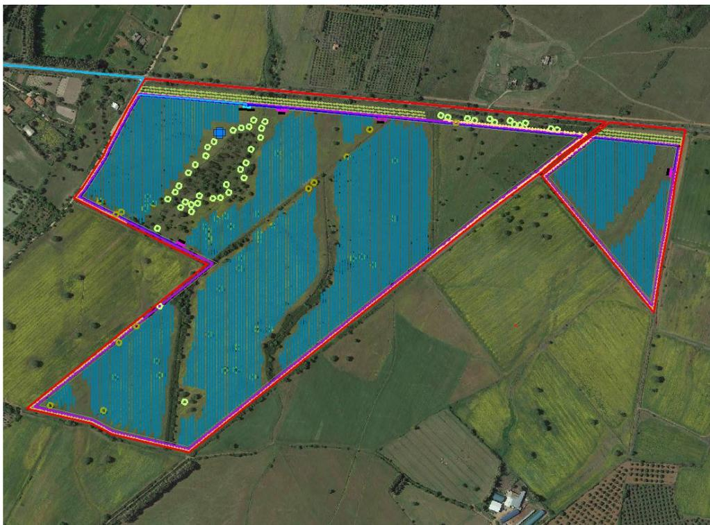
**Figura 17 Layout con indicazione della fascia di mitigazione (olive e siepe a macchia mediterranea).**
