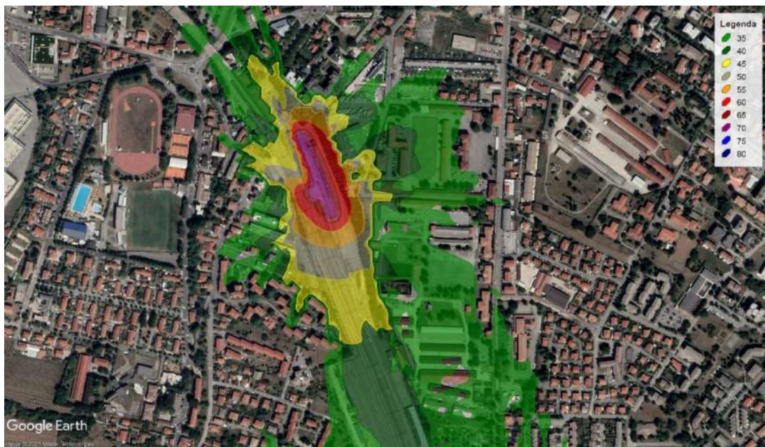
Figura 4-26 Output del modello di simulazione in fase di cantiere (periodo diurno) – CA.01 armamento
