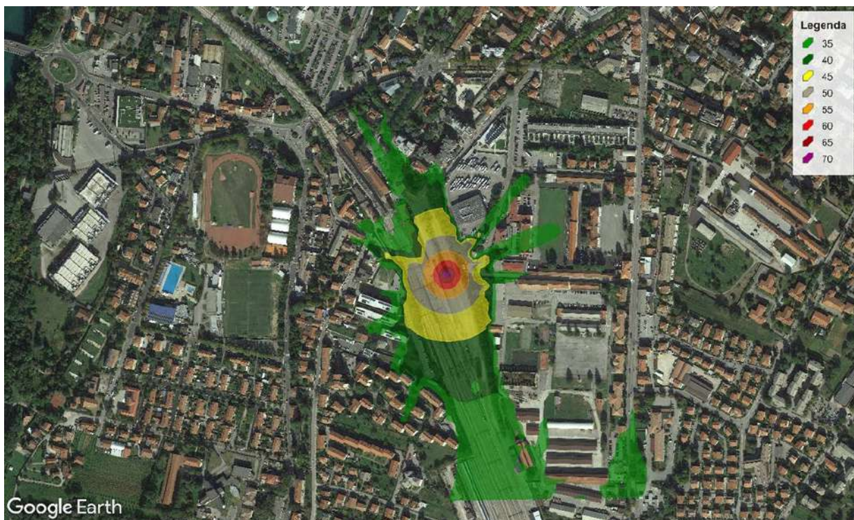
Figura 4.30. Output del modello di simulazione in fase di cantiere (CA.01 cantiere armamento) – periodo diurno
