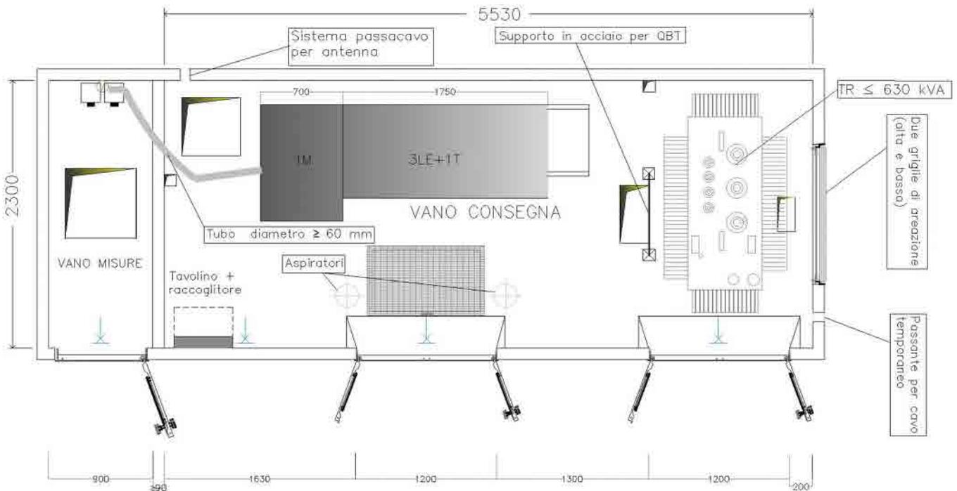
Figura 3 - Pianta dimensionale e funzionale Standard Box Cliente – Ulteriori dimensioni nel §14.3
