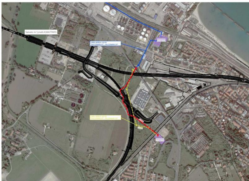
Figura 1 – Planimetria degli interventi previsti. In giallo la linea in demolizione ed in rosso la linea da realizzare
