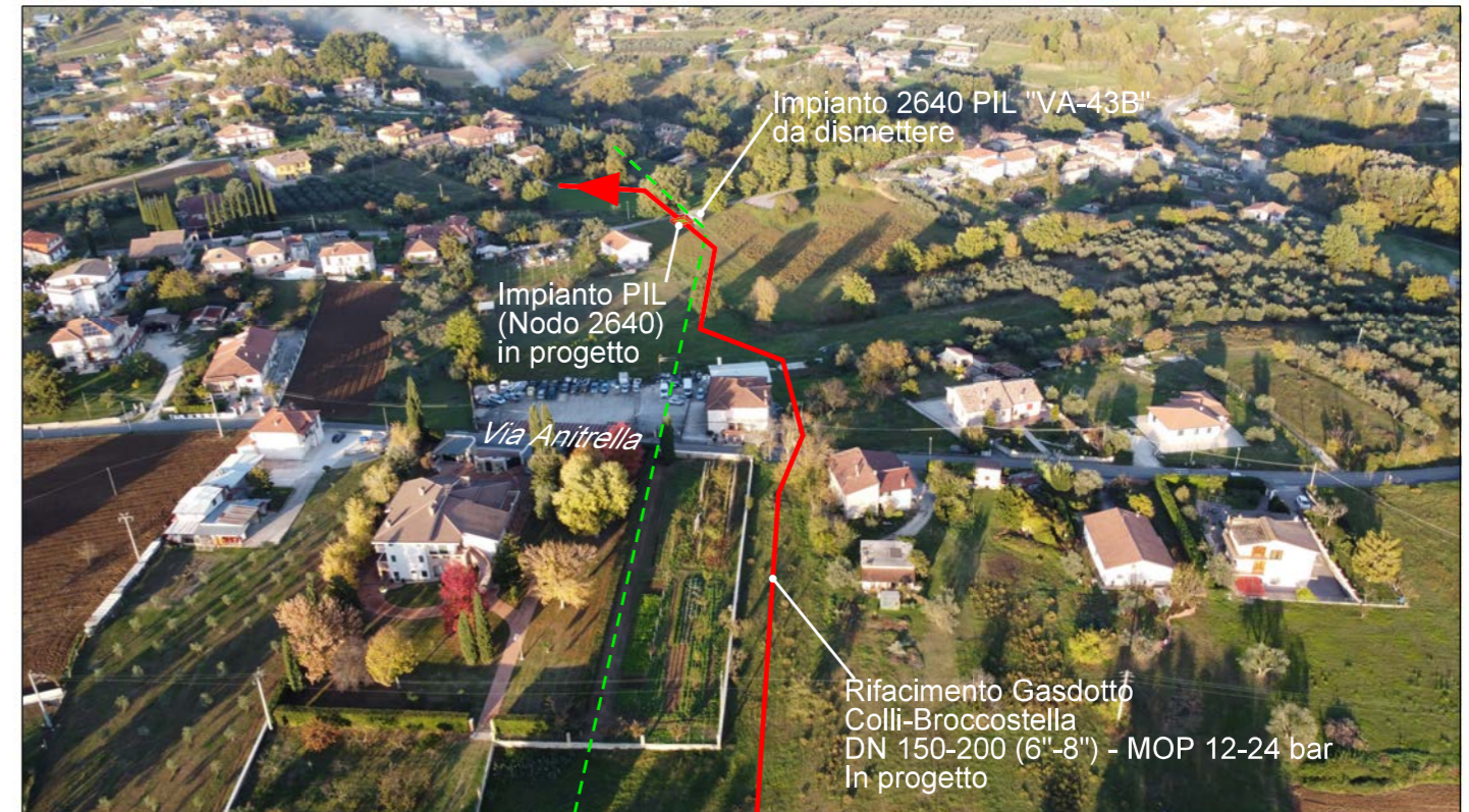
Panoramica del nuovo tratto con attraversamento di Via Anitrella
