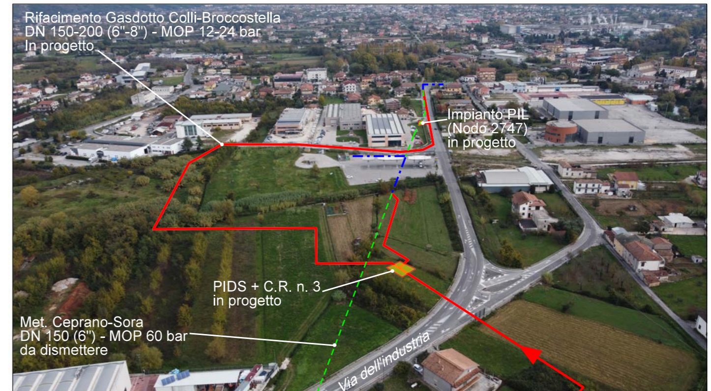
Attraversamento di Via dell'industria tramite tecnologia dello spingitubo e realizzazione della Cabina di Riduzione
