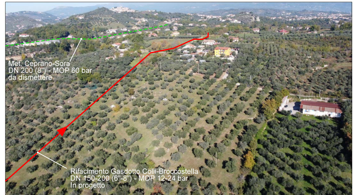
Percorrenza su aree agricole con olivi senza interferire con il centro abitato del comune di Monte San Giovanni Campano
