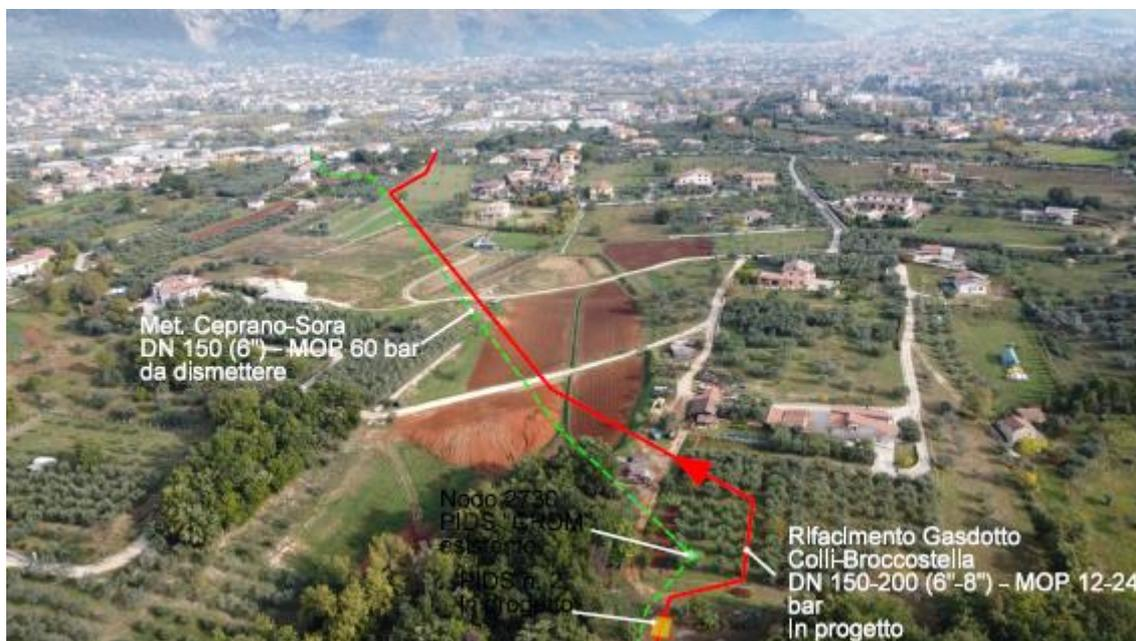
Figura 5.1.1-13 – Panoramica del nuovo tratto con ubicazione PIDS n. 2 e percorrenza su area agricola lontana da fenomeni franosi. (in rosso il tracciato in progetto, in verde la dismissione e in blu in esercizio).
