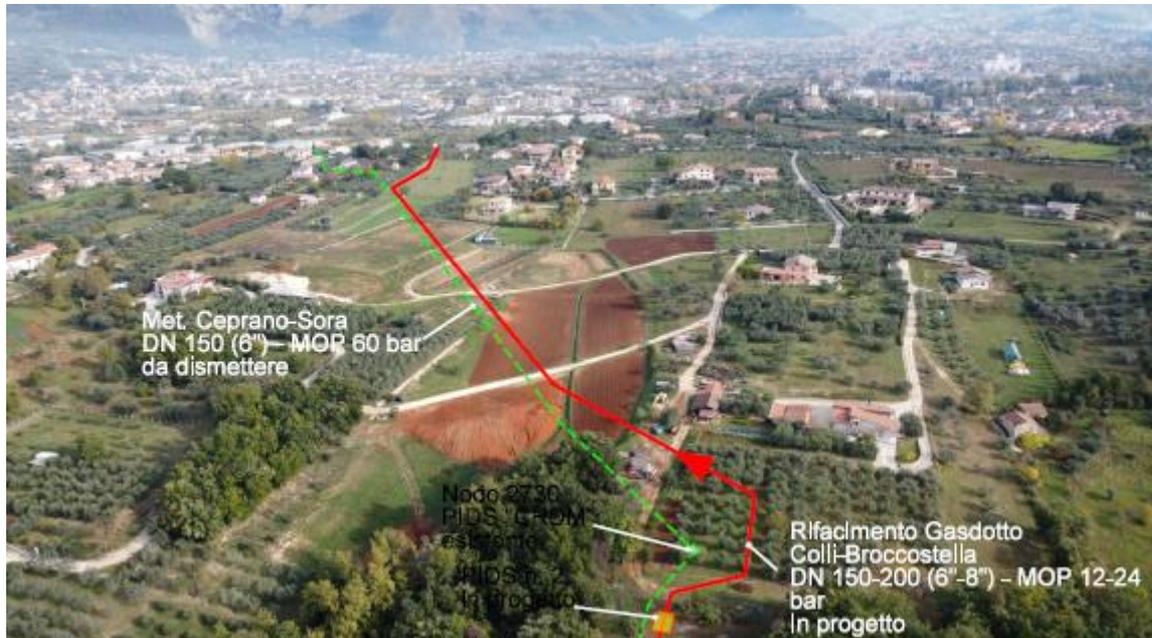
Figura 1.1.1/D - Panoramica del nuovo tratto con ubicazione PIDS n. 2 e percorrenza su area agricola lontana da fenomeni franosi. (in rosso il tracciato in progetto, in verde la dismissione e in blu in esercizio).
