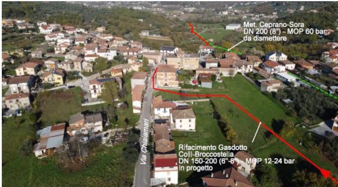
Figura 5.1.1-8 – Panoramica del nuovo tratto con percorrenza su strade asfaltate nel centro abitato di Chiaiamari. (in rosso il tracciato in progetto, in verde la dismissione).
