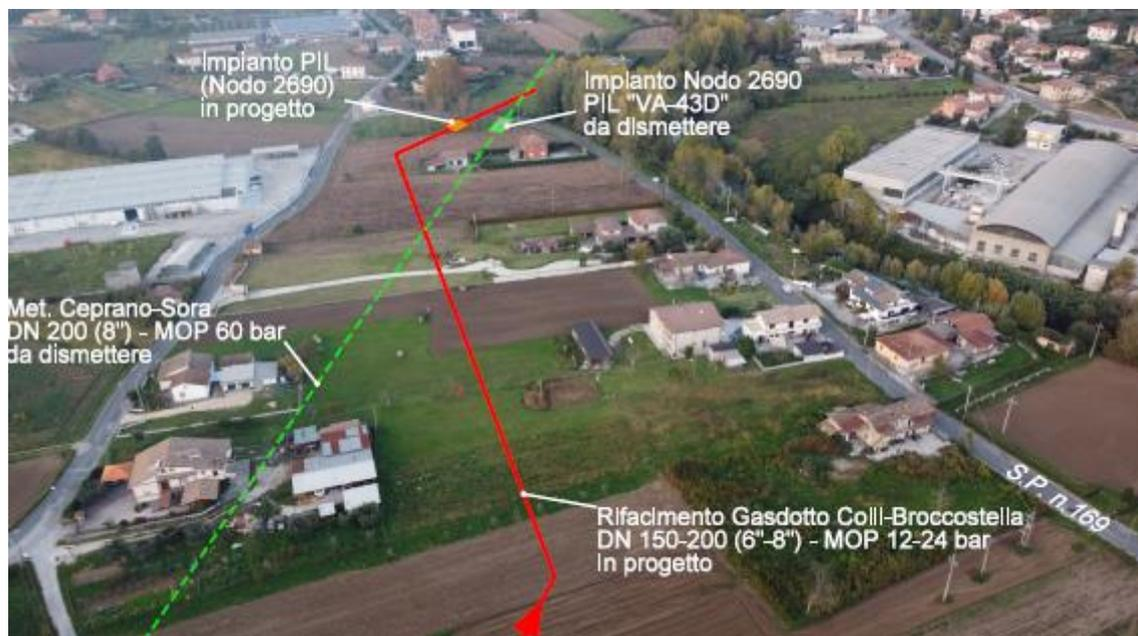
**Figura 5.1.1-11 – Panoramica del nuovo tratto con percorrenza su area agricola e attraversamento SP n. 169. (in rosso il tracciato in progetto, in verde la dismissione).**
