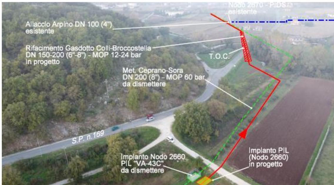
**Figura 5.1.1-10 – Panoramica del nuovo tratto con attraversamento in TOC della SP n.169 e torrente Forma Taverna. (in rosso il tracciato in progetto, in verde la dismissione).**
