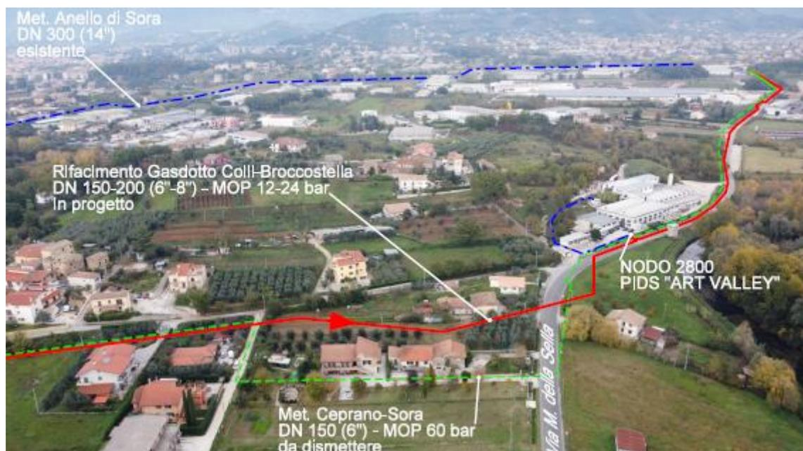
Figura 5.1.1-18 – Panoramica del nuovo tratto con l’attraversamento in spingitubo di via Madonna della Sella e percorrenza stradale. (in rosso il tracciato in progetto, in verde la dismissione, in blu met. esistente).
