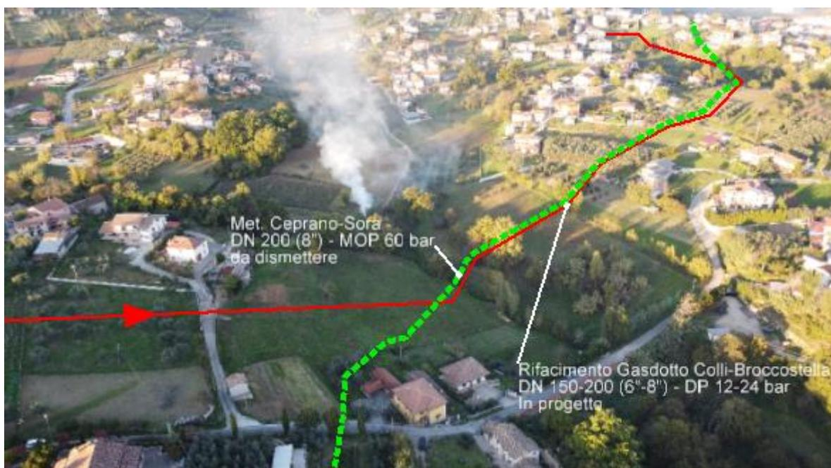
**Foto 5.2.1-3** Tratto in progetto necessario ad evitare l'area instabile (PAI/IFFI). In rosso il nuovo tracciato e in verde la dismissione.
