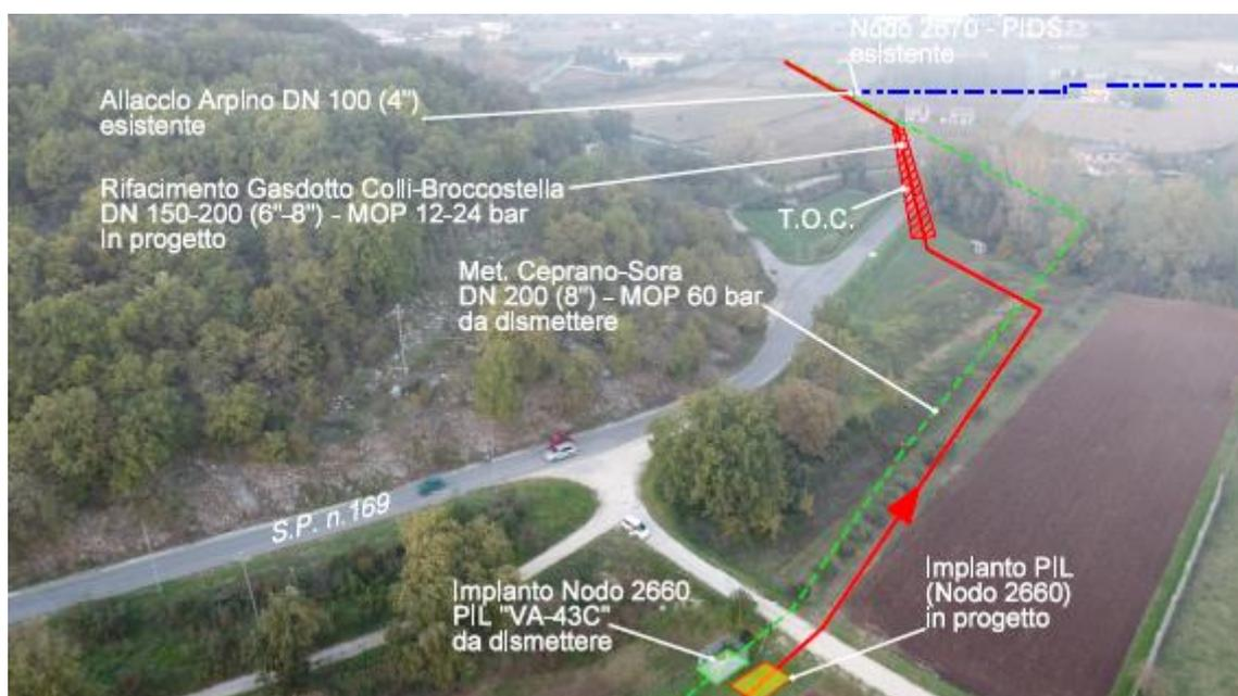
**Figura 1.1.1/C - Panoramica del nuovo tratto con attraversamento in TOC della SP n.169 e torrente Forma Taverna. (in rosso il tracciato in progetto, in verde la dismissione).**
