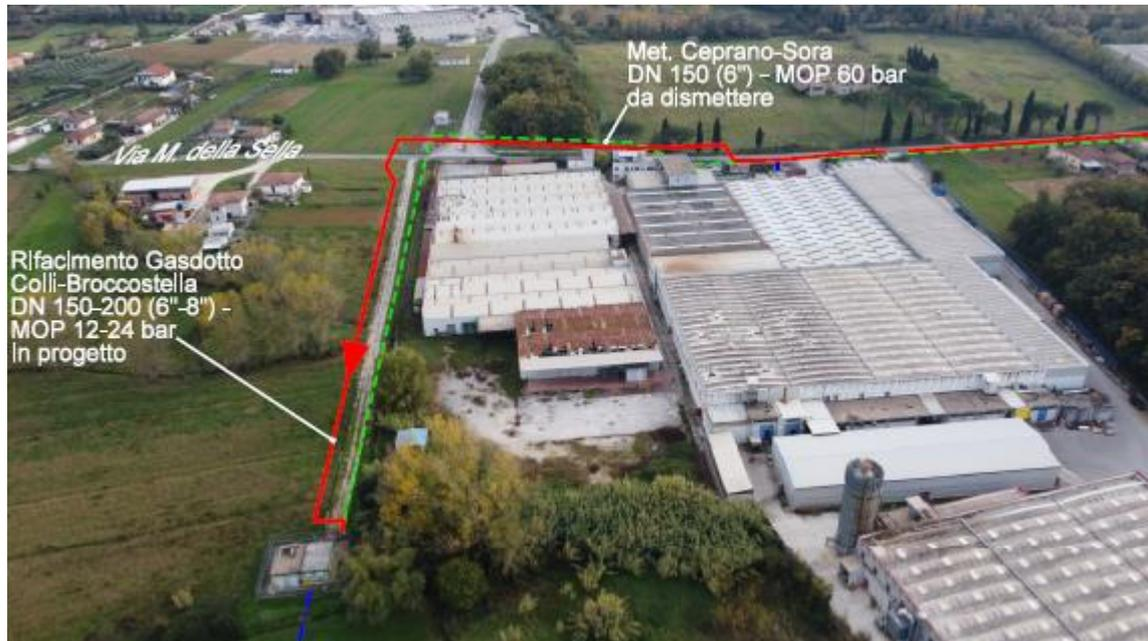
Figura 5.1.1-19 – Panoramica del nuovo tratto con l’attraversamento di Via Madonna della Stella e ricollegamento all’impianto di Broccostella. (in rosso il tracciato in progetto, in verde la dismissione, in blu met. in dismissione).
