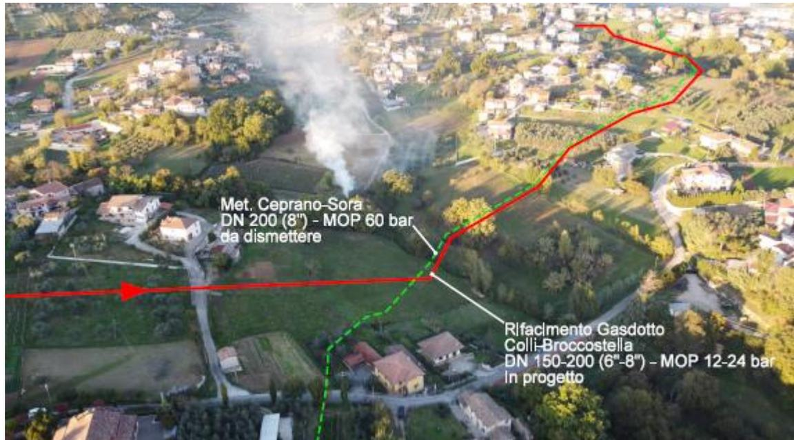
Figura 5.1.1-7 – Panoramica del nuovo tratto con parallelismo alla condotta da dismettere. (in rosso il tracciato in progetto, in verde la dismissione).
