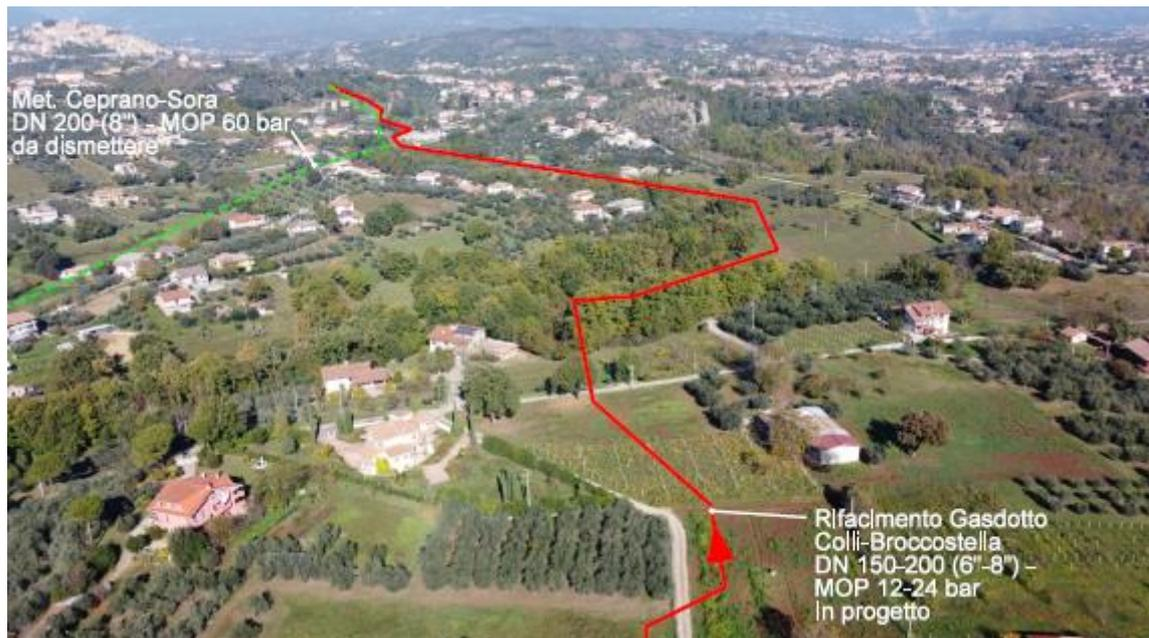
**Figura 5.1.1-4 – Panoramica del nuovo tratto che attraversa strade sterrate e la SP n. 100. (in rosso il tracciato in progetto, in verde la dismissione).**
