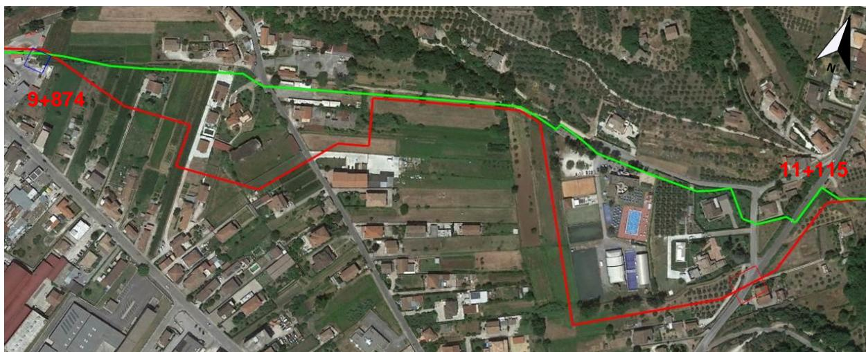
Foto 5.2.1-8 Tratto in dismissione interferente con centro sportivo e agglomerati di case. In rosso il nuovo tracciato e in verde la dismissione.
