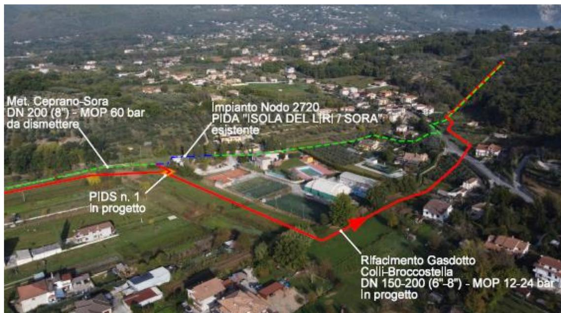
Figura 5.1.1-12 – Panoramica del nuovo tratto con ubicazione PIDS n. 1 in progetto e tracciato in affiancamento al Centro Sportivo “Giardino dello Sport”. (in rosso il tracciato in progetto, in verde la dismissione).
