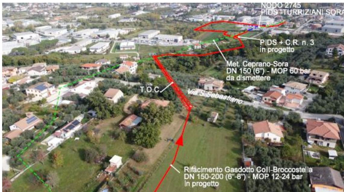
Figura 5.1.1-14 – Panoramica del nuovo tratto con l'attraversamento in TOC di area boscata e sullo sfondo andamento condotte in prossimità del distributore "Turriziani". (in rosso il tracciato in progetto, in verde la dismissione).
