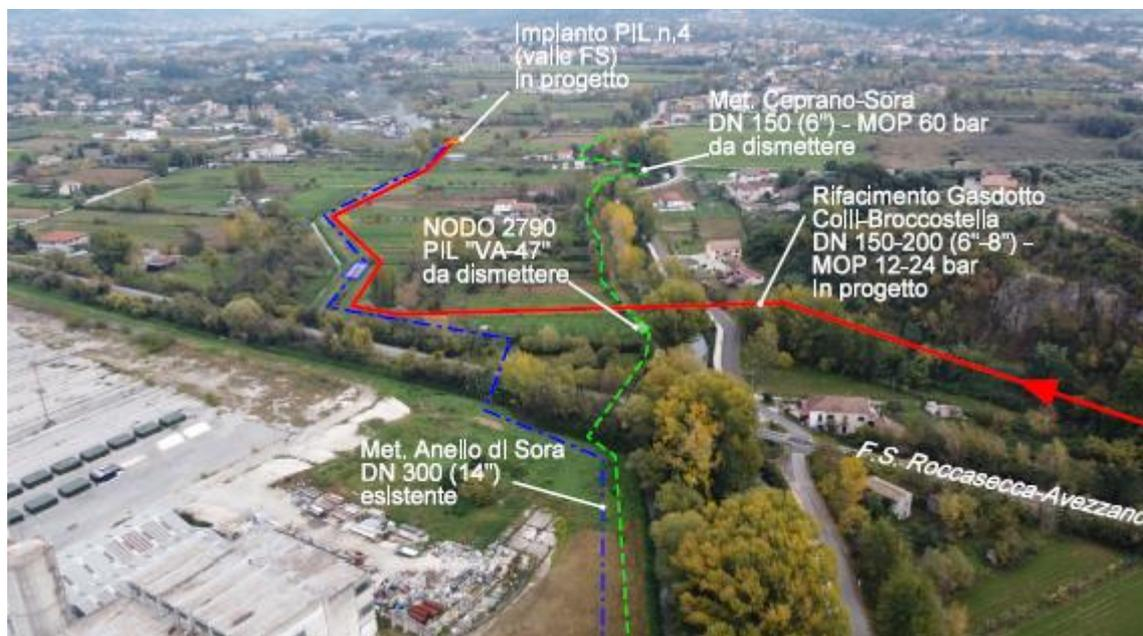
Figura 5.1.1-16 – Panoramica del nuovo tratto con l'attraversamento in spingitubo del Fiume Fibreno e parallelismo con met. Anello di Sora DN 150 (6"). (in rosso il tracciato in progetto, in verde la dismissione, in blu met. in esercizio).
