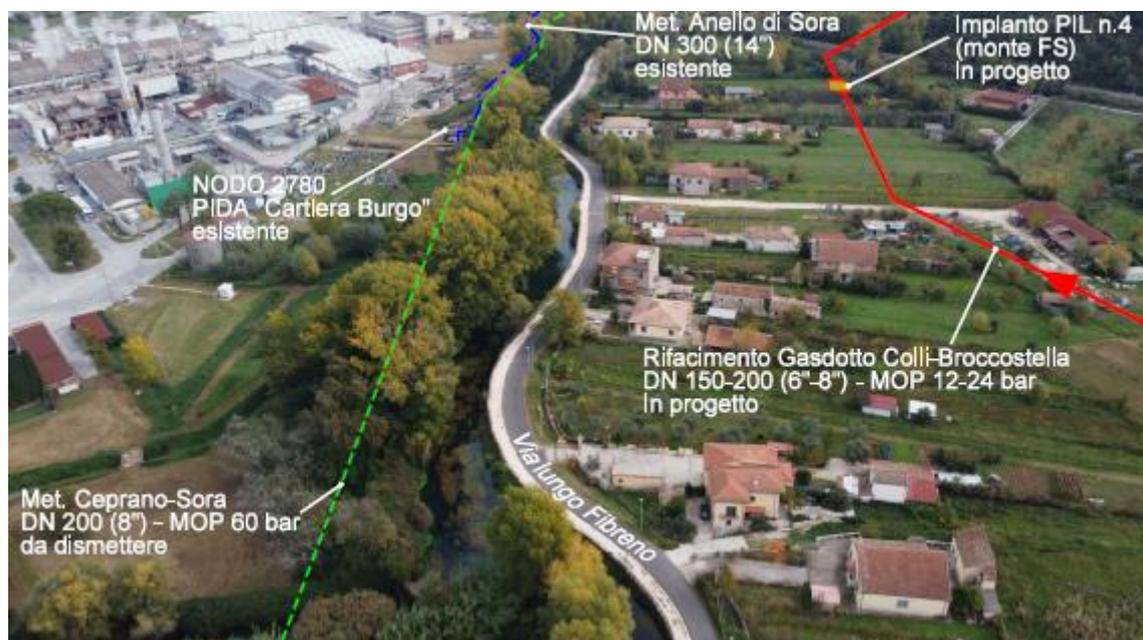
Figura 5.1.1-15 – Panoramica del nuovo tratto con percorrenza su aree agricole e nuovo impianto PIL n.4. (in rosso il tracciato in progetto, in verde la dismissione, in blu met. in esercizio).
