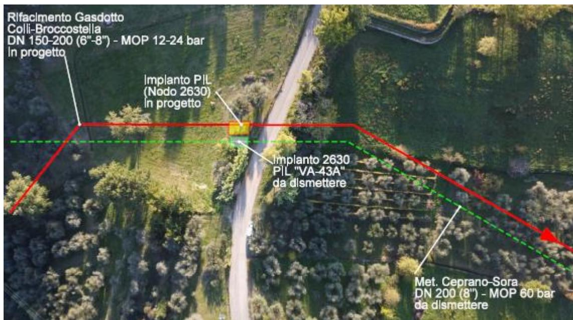
Figura 5.1.1-5 – Panoramica del nuovo tratto con ubicazione del nuovo PIL 2630 (in rosso il tracciato in progetto, in verde la dismissione).
