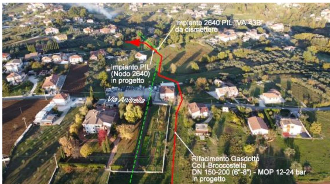
Figura 5.1.1-6 – Panoramica del nuovo tratto con attraversamento di Via Anitrella (in rosso il tracciato in progetto, in verde la dismissione).
