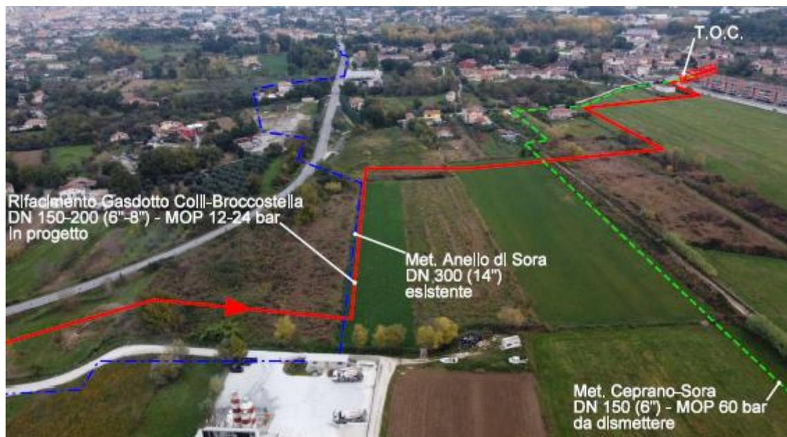
Figura 5.1.1-17 – Panoramica del nuovo tratto con l’attraversamento in TOC di via Bonomi. (in rosso il tracciato in progetto, in verde la dismissione).
