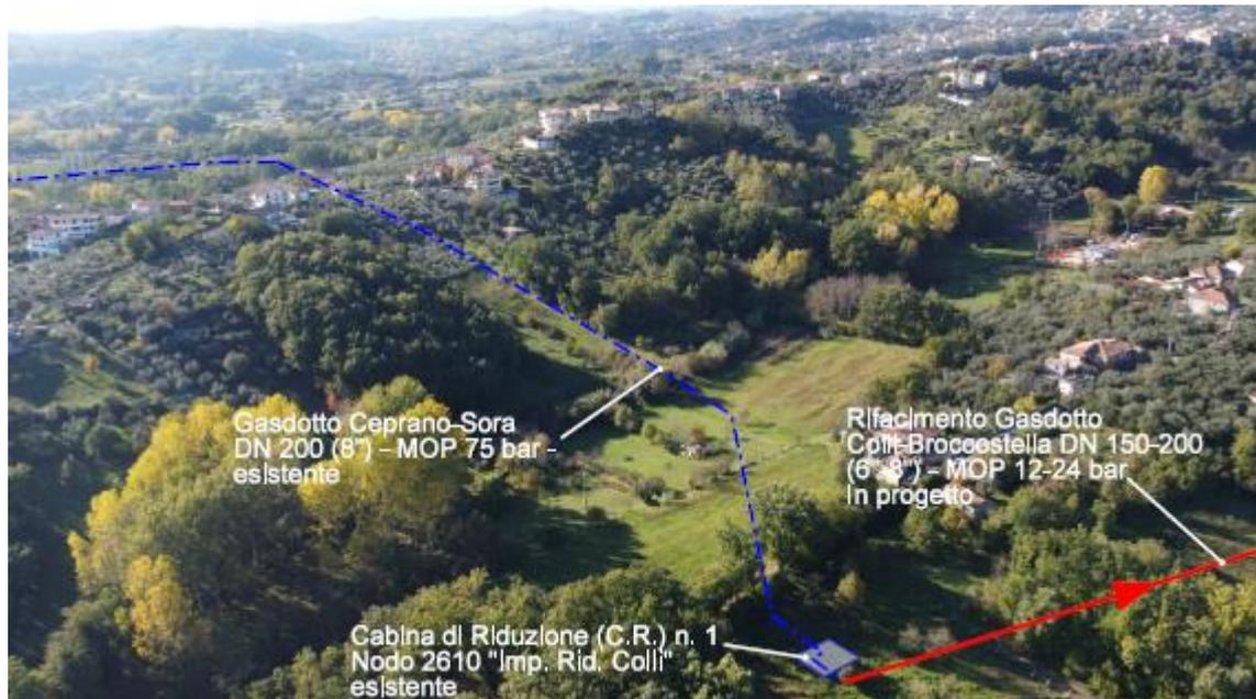
**Figura 5.1.1-2 – Panoramica del punto di partenza del Gasdotto Colli-Broccostella DN 150-200 (6"-8") - MOP 12-24 bar oggetto di rifacimento. (in rosso il tracciato in progetto, in blu in esercizio).**
