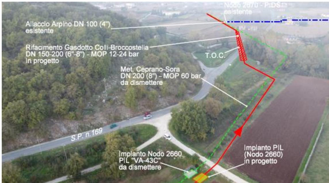
**Figura 4-D: Panoramica del nuovo tratto con attraversamento in TOC della SP n.169 e torrente Forma Taverna. (in rosso il tracciato in progetto, in verde la dismissione).**
