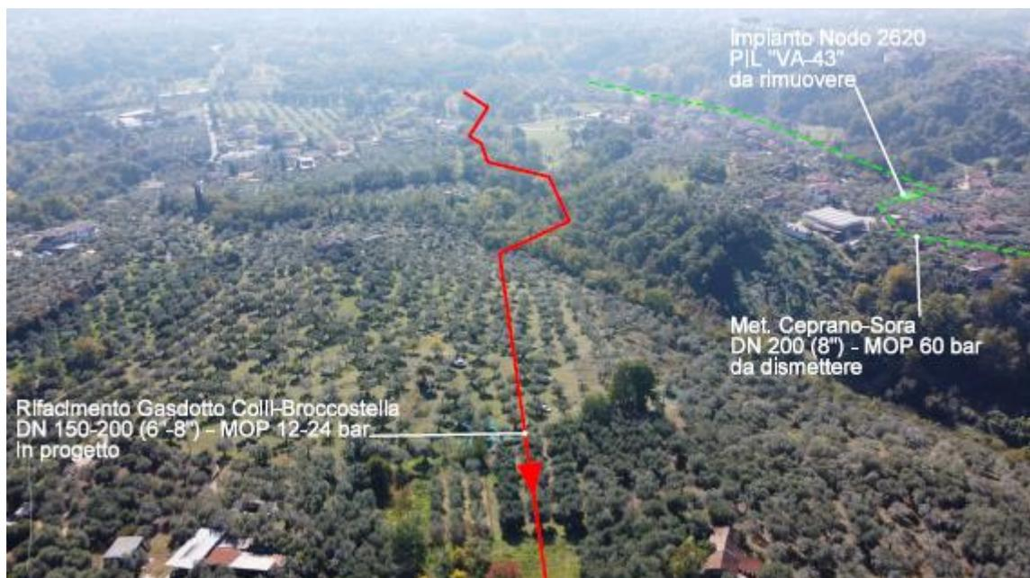
Figura 3-C: Panoramica del nuovo tratto di gasdotto che risale un leggero versante con presenza di olivi. (in rosso il tracciato in progetto, in verde la dismissione).
