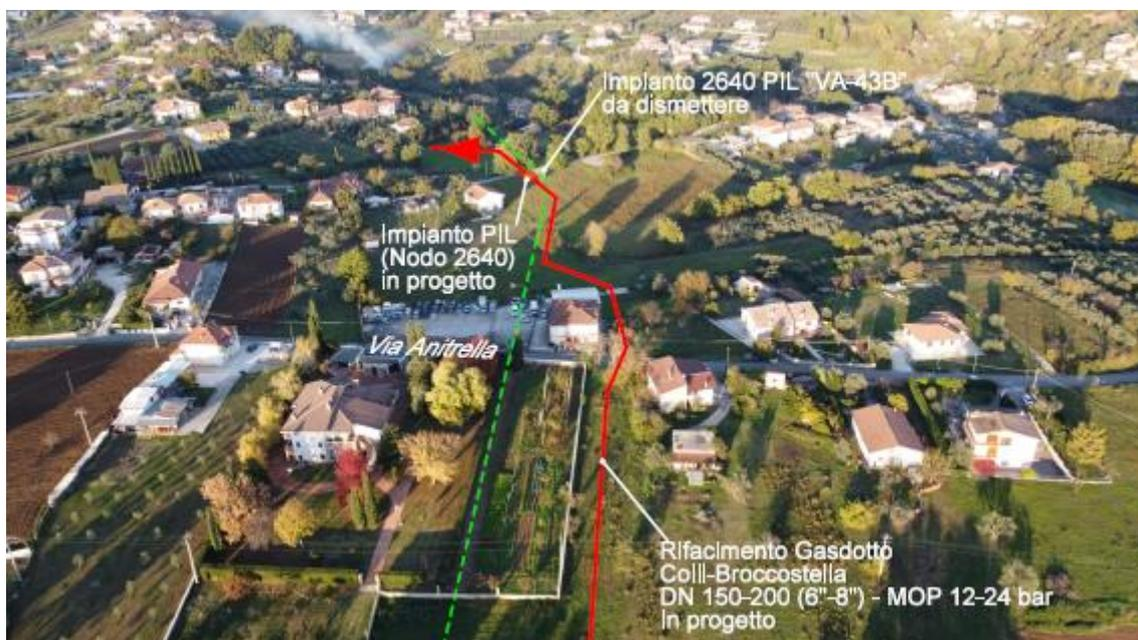
**Figura 3-D: Panoramica del nuovo tratto con attraversamento di Via Anitrella (in rosso il tracciato in progetto, in verde la dismissione).**
