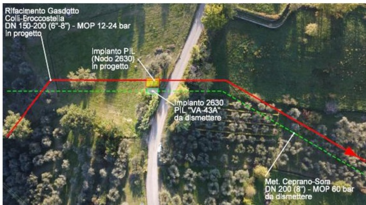
Fig. 6 - Panoramica del nuovo tratto con ubicazione del nuovo PIL 2630 (in rosso il tracciato in progetto, in verde la dismissione).
