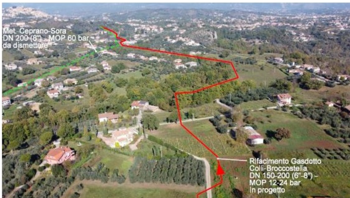
Fig. 5 - Panoramica del nuovo tratto che attraversa strade sterrate e la SP n. 100. (in rosso il tracciato in progetto, in verde la dismissione).
