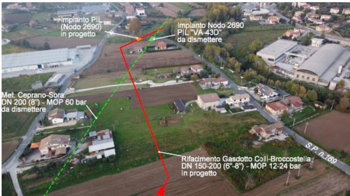
Fig. 11 -Panoramica del nuovo tratto con percorrenza su area agricola e attraversamento SP n. 169. (in rosso il tracciato in progetto, in verde la dismissione).
