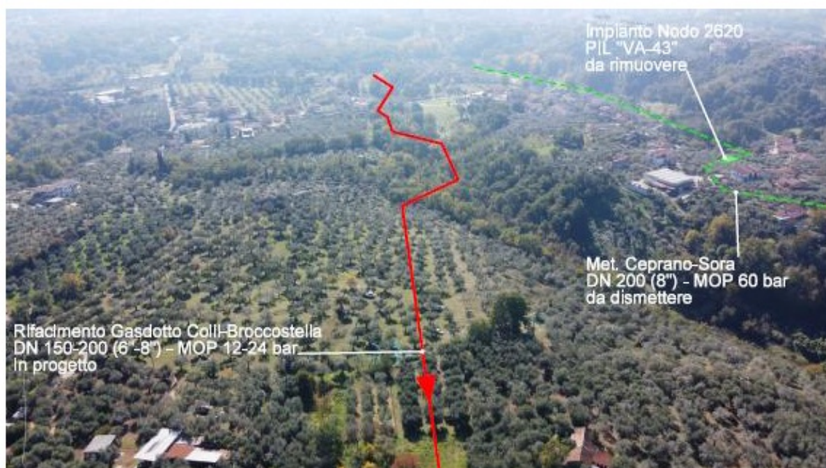
Fig. 4 - Panoramica del nuovo tratto di gasdotto che risale un leggero versante con presenza di olivi. (in rosso il tracciato in progetto, in verde la dismissione).
