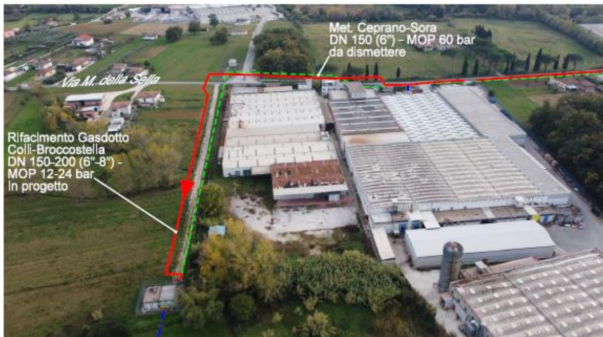
Fig. 19 - Panoramica del nuovo tratto con l'attraversamento di Via Madonna della Stella e ricollegamento all'impianto di Broccostella. (in rosso il tracciato in progetto, in verde la dismissione, in blu met. in dismissione).
