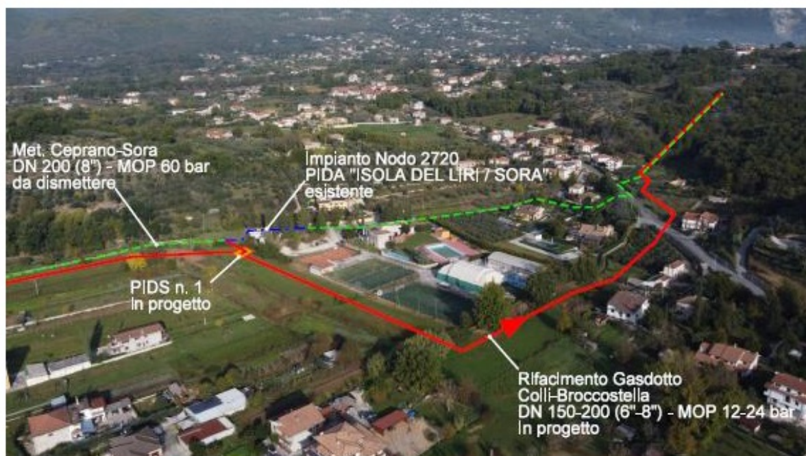
Fig. 12 - Panoramica del nuovo tratto con ubicazione PIDS n. 1 in progetto e tracciato in affiancamento al Centro Sportivo "Giardino dello Sport". (in rosso il tracciato in progetto, in verde la dismissione).
