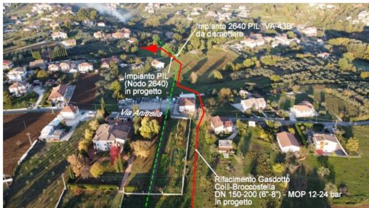
Fig. 7 - Panoramica del nuovo tratto con attraversamento di Via Anitrella (in rosso il tracciato in progetto, in verde la dismissione).
