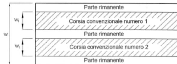
Figura 5.1 - Esempio di numerazione delle corsie
