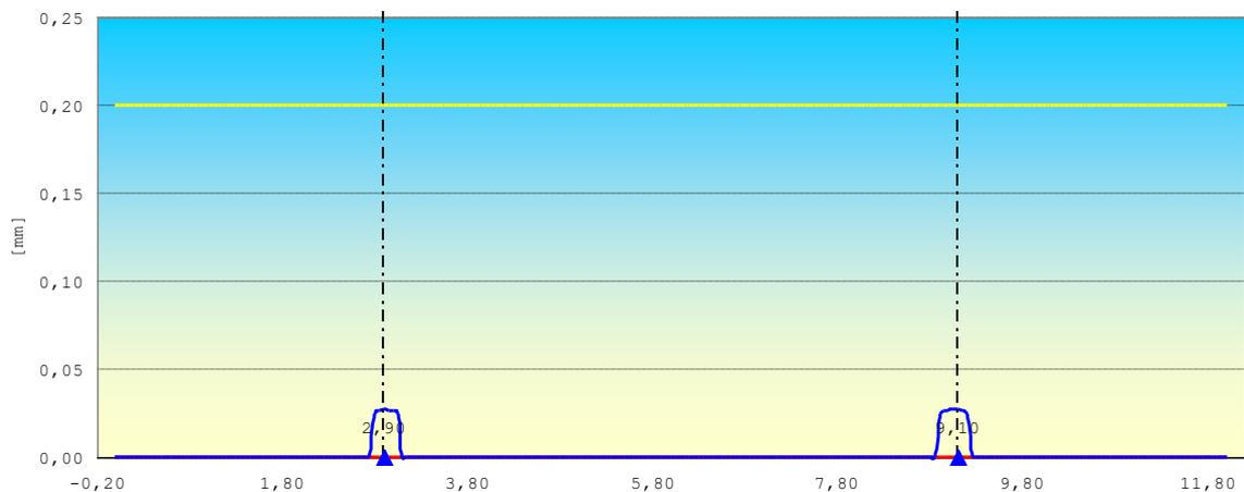
Figura 10.15 - Apertura delle fessure nella combinazione QUASI PERMANENTE (l'apertura è nulla nelle sezioni in cui non è superato il momento di prima fessurazione)
