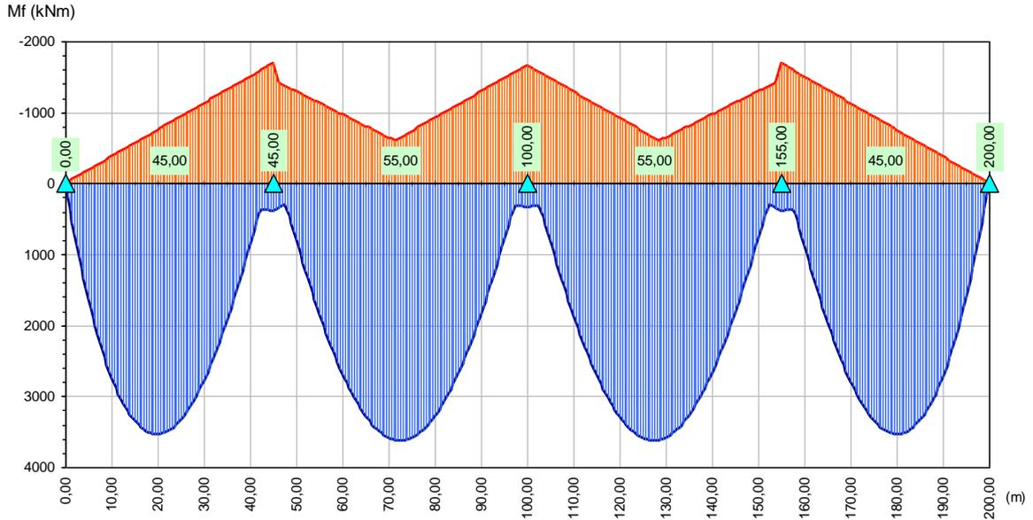
**CARICHI MOBILI FATICA -  $T_{max}$  e  $T_{min}$**
