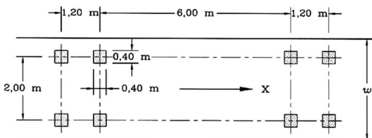
Figura 5.3 - Modello di carico di fatica 3
