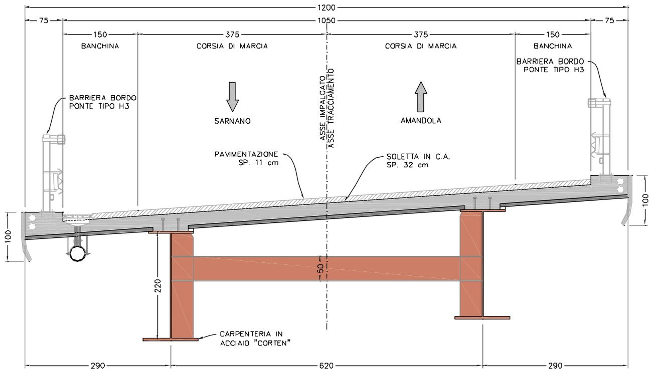
**Figura 2.2 - Sezione trasversale impalcato**
