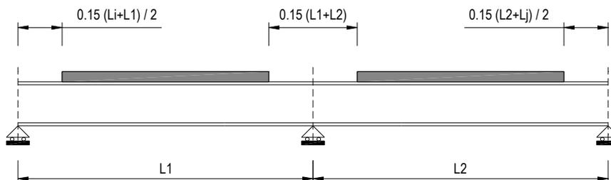
Figura 7.1 - Modellazione degli effetti dovuti alla fessurazione
