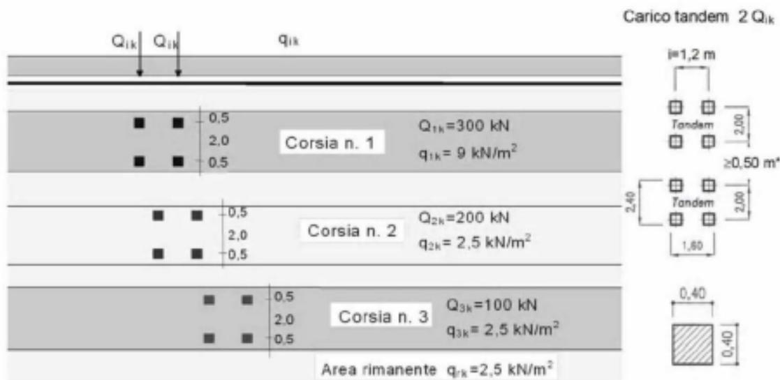
Figura 5.2 – Schema di carico 1 - dimensioni in [m]
