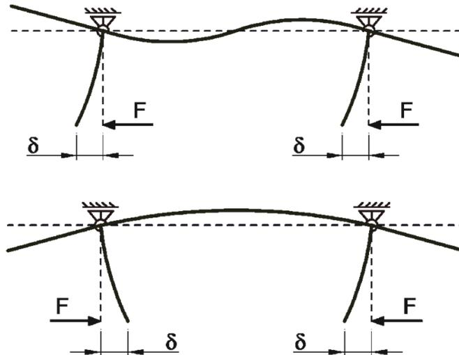
Figura 9-5 - Forme di instabilità del generico telaio trasversale
