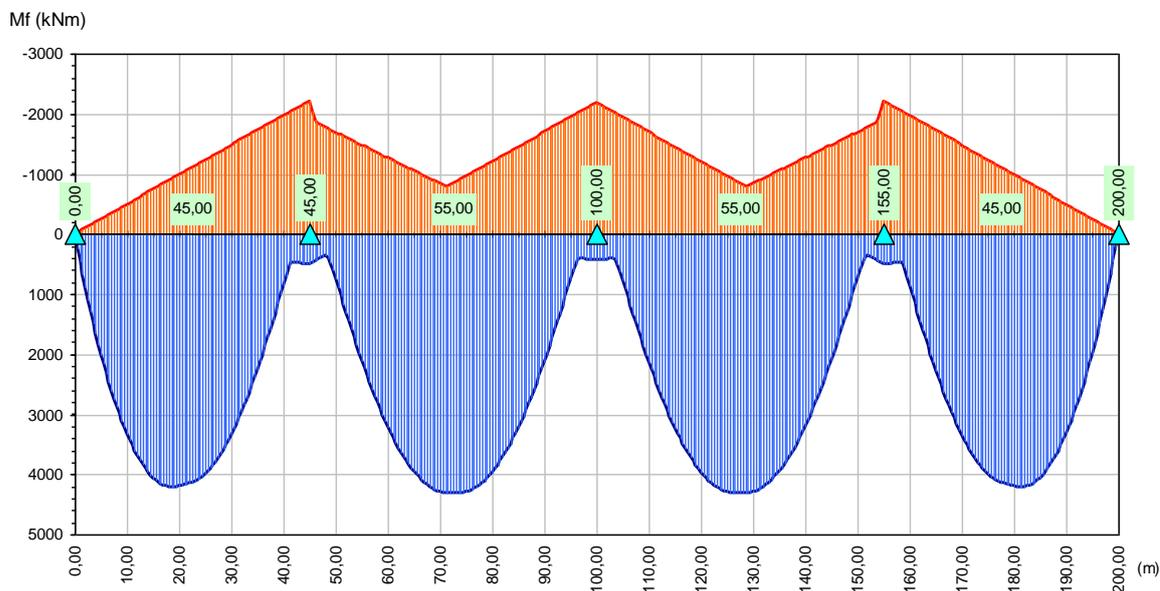
**CARICHI MOBILI FATICA -  $T_{max}$  e  $T_{min}$**
