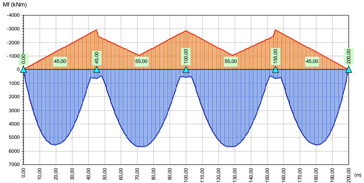
**CARICHI MOBILI FATICA -  $T_{max}$  e  $T_{min}$**
