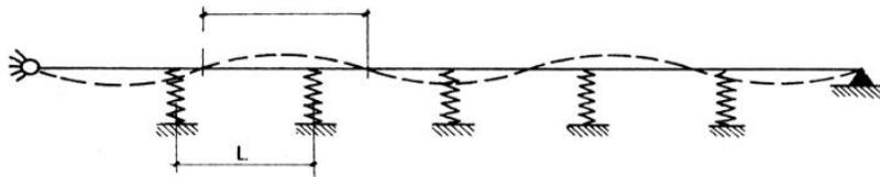
Figura 9.4 – Schema di asta su appoggi elastici discreti
