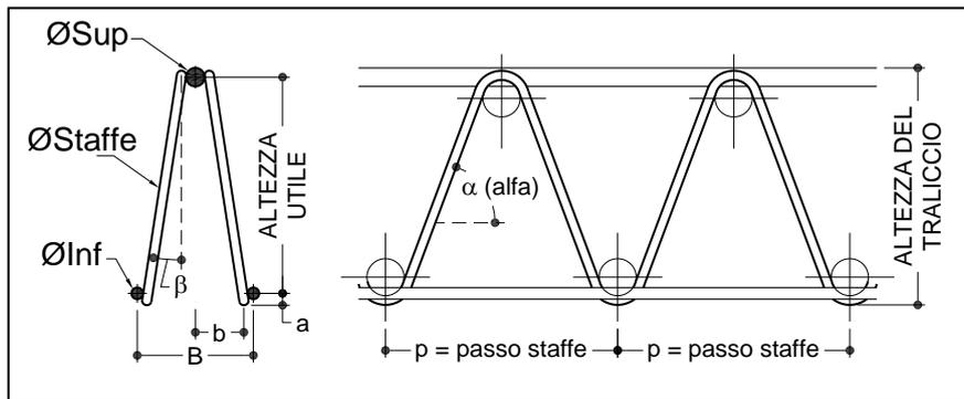
Figura 10.1 - Geometria dei tralicci delle predalles
