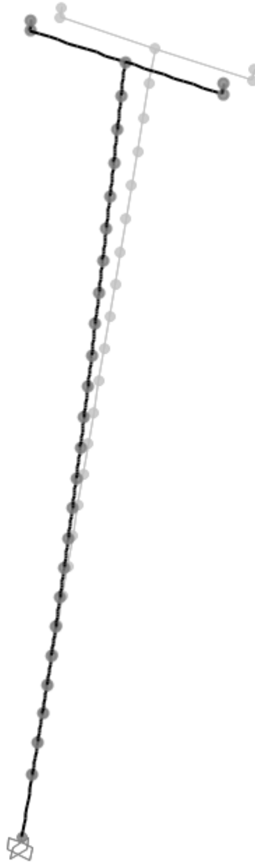
Figura 15-4; risultato dell'analisi di buckling - primo modo
