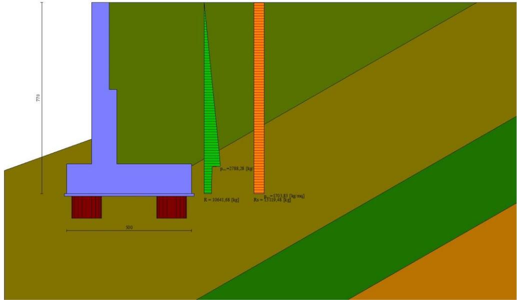
Fig. 5 - Diagramma delle pressioni (combinazione sismica) (Combinazione n° 2)
