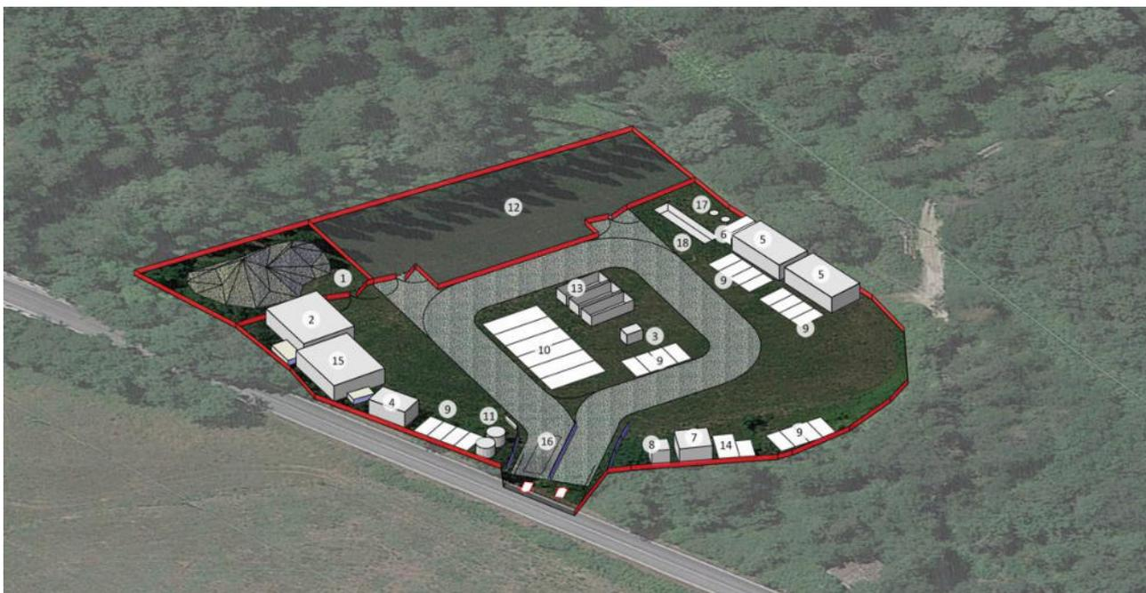
**Fig. 2 – Layout area di cantiere n° 1 – cantiere operativo e logistico**
