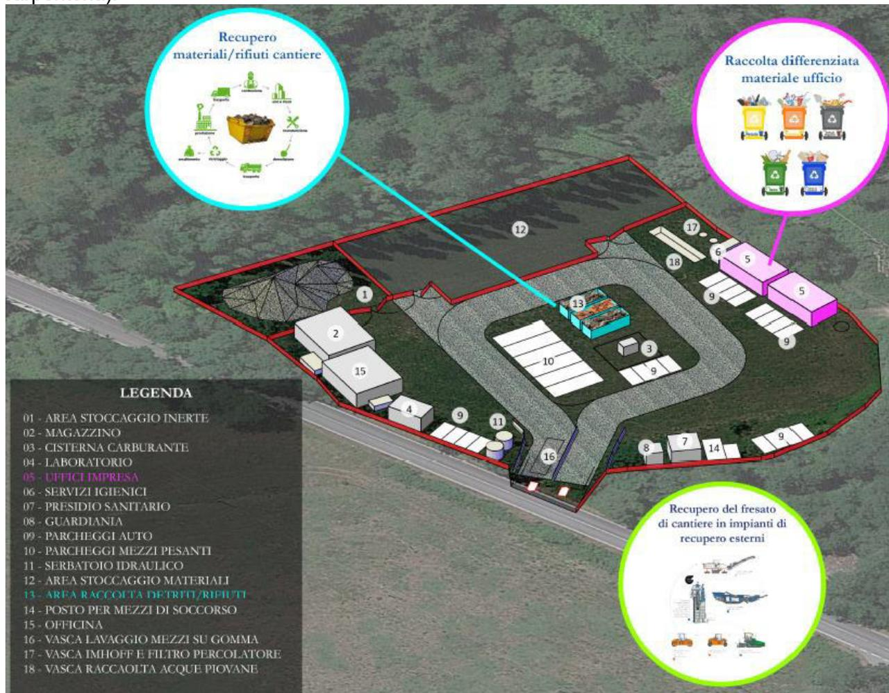
**Fig. 5 – Layout area di cantiere n° 1 – trattamento materiali / rifiuti**
