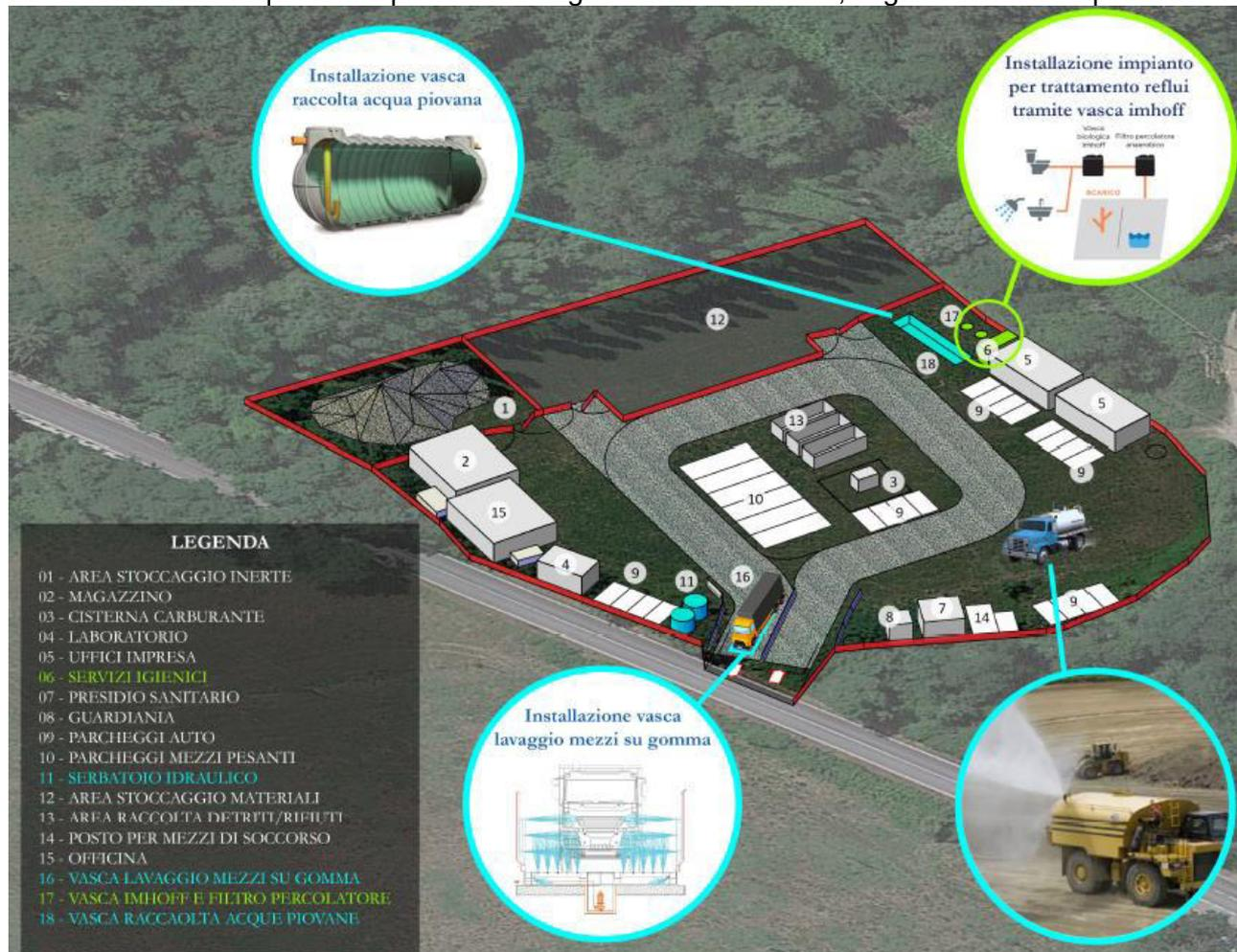
**Fig. 4 – Layout area di cantiere n° 1 – trattamento acque**
