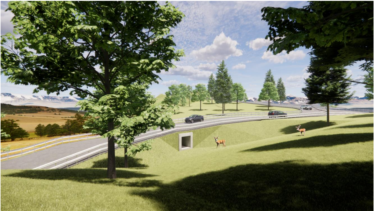
Figura 5-5 – post operam n. 3 – attraversamento scatolare 2,0x2,0 m
