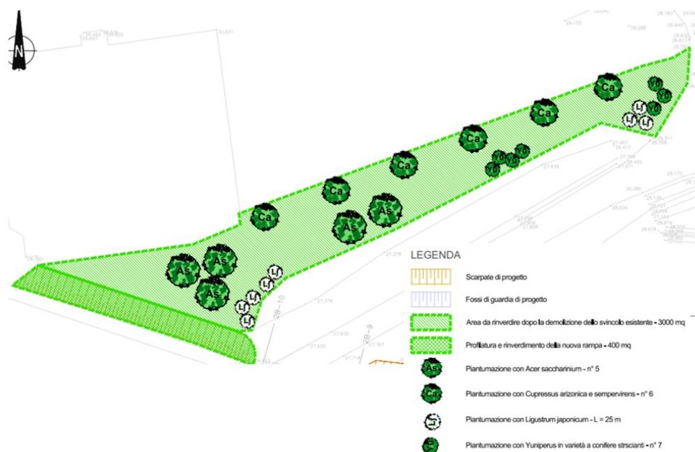
**Figura 7:** Planimetria della sistemazione ambientale dello svincolo dismesso (Fonte: Documentazione di chiarimento)
