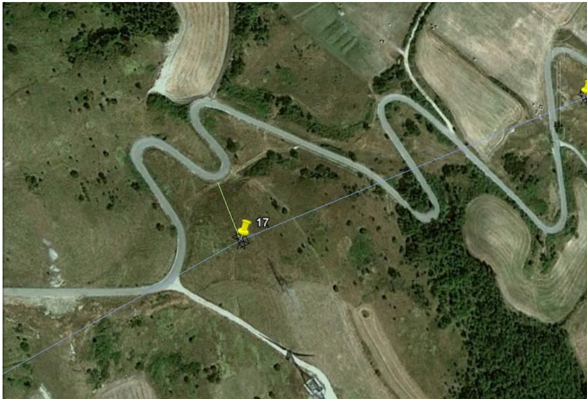
Foto 4 - Foto aerea in prossimità del sostegno 17: un brevissimo tratto di pista raccorda il sito del sostegno alla viabilità esistente
