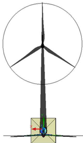
Proiezione dell'ombra indotta dall'aerogeneratore con rotore perpendicolare alla linea sole - recettore
