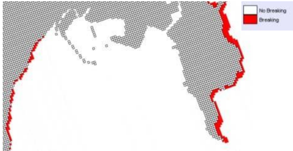
Figura 15.1.Fasce di frangenza in presenza delle opere in progetto sotto l'attacco d'onda da D=105°N e R=100 anni.
