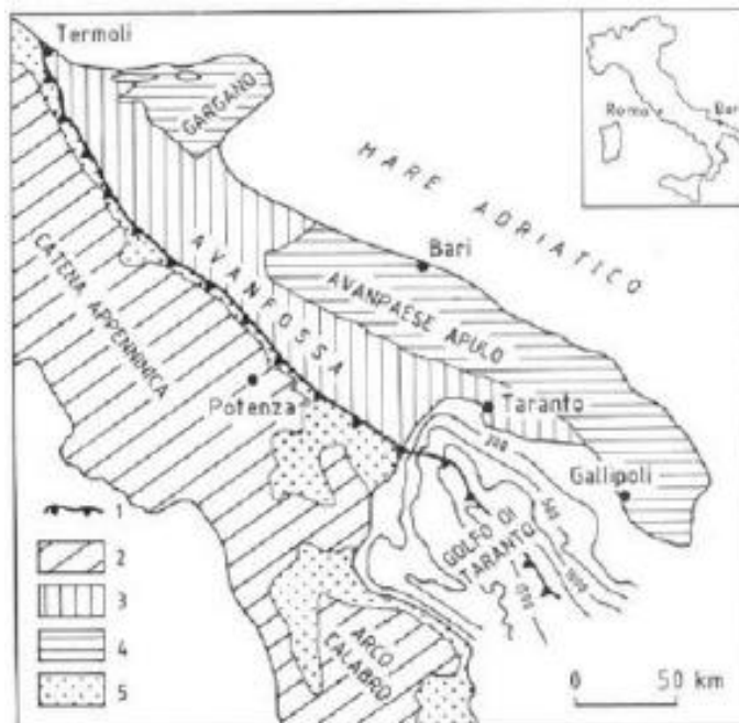
Schema dei principali domini geodinamici: 1) Limite delle Unità Appenniniche Alloctone; 2) Catena Appenninica ed Arco Calabro; 3) Avanfossa; 4) Avampaese Apulo-Garganico; 5) Bacini Plio-Pleistocenici – Fonte: Zezza et al., 1984)
