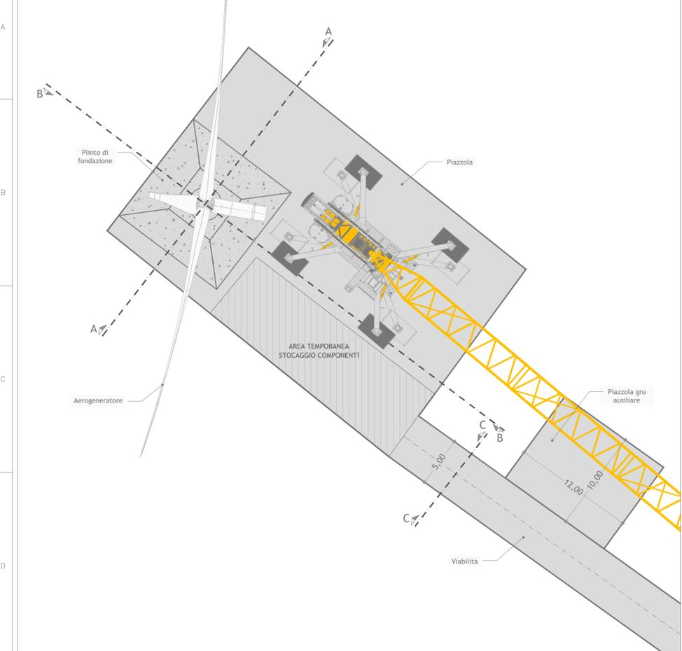
SEZIONI PIAZZOLA, VIABILITÀ PLINTO DI FONDAZIONE ESISTENTE FASE DISMISSIONE
