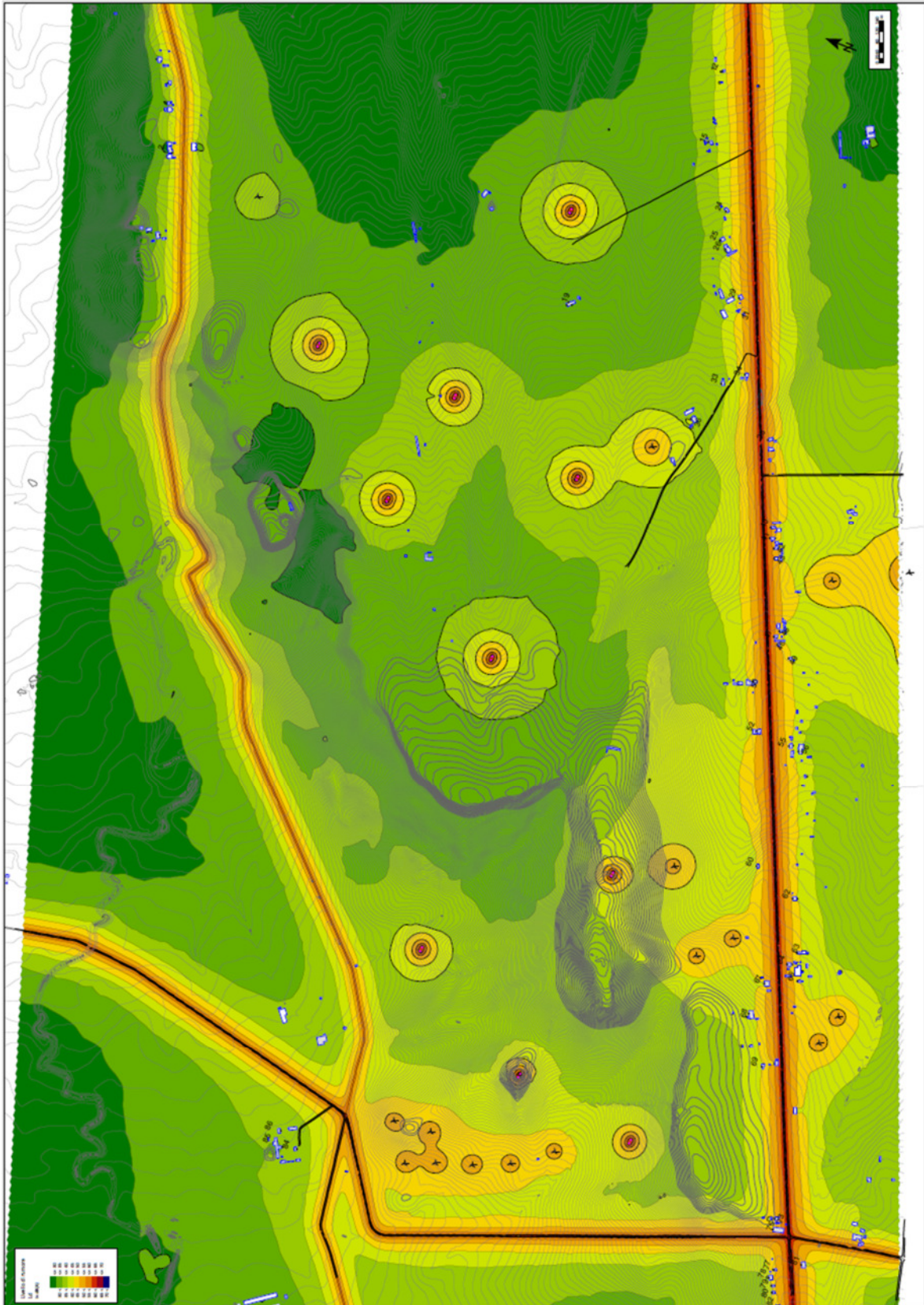
Figura 14: Mappa acustica di propagazione diurna CO- Cantieri MONTAGGIO nuove turbine
