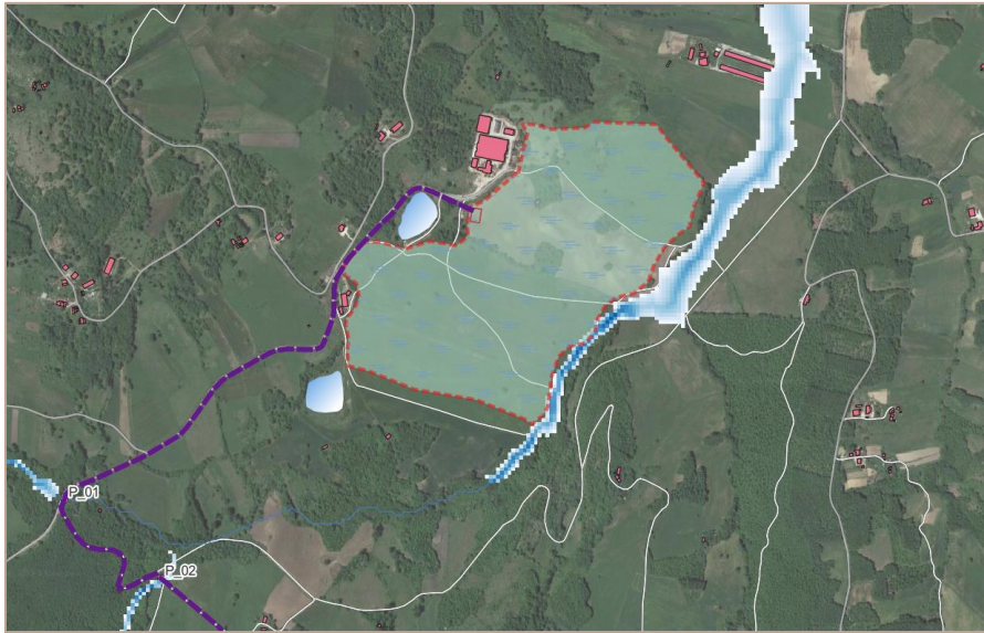
Fig. 13 - Estratto planimetrico della zona di impianto con le aree esondabili per il tempo di ritorno di 200 anni
