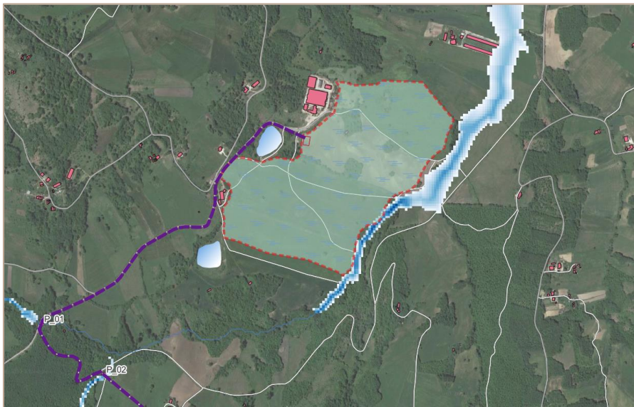
Fig. 14 - Estratto planimetrico della zona di impianto con le aree esondabili per il tempo di ritorno di 500 anni
