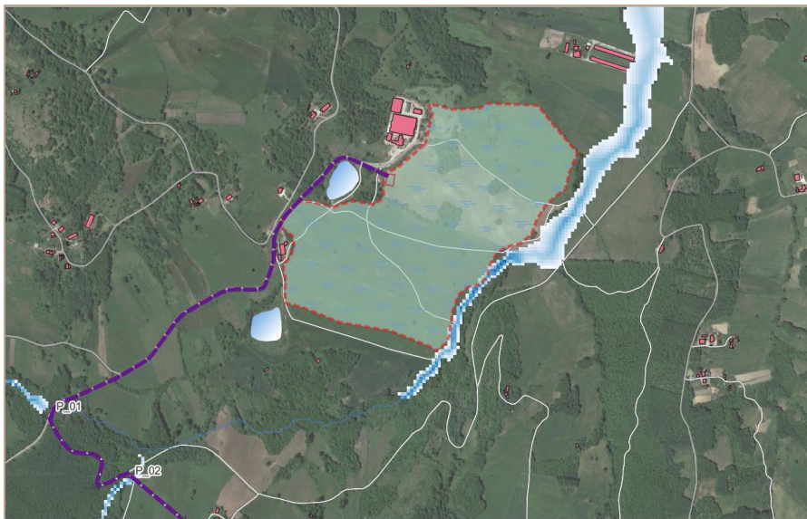
Fig. 12 - Estratto planimetrico della zona di impianto con le aree esondabili per il tempo di ritorno di 100 anni
