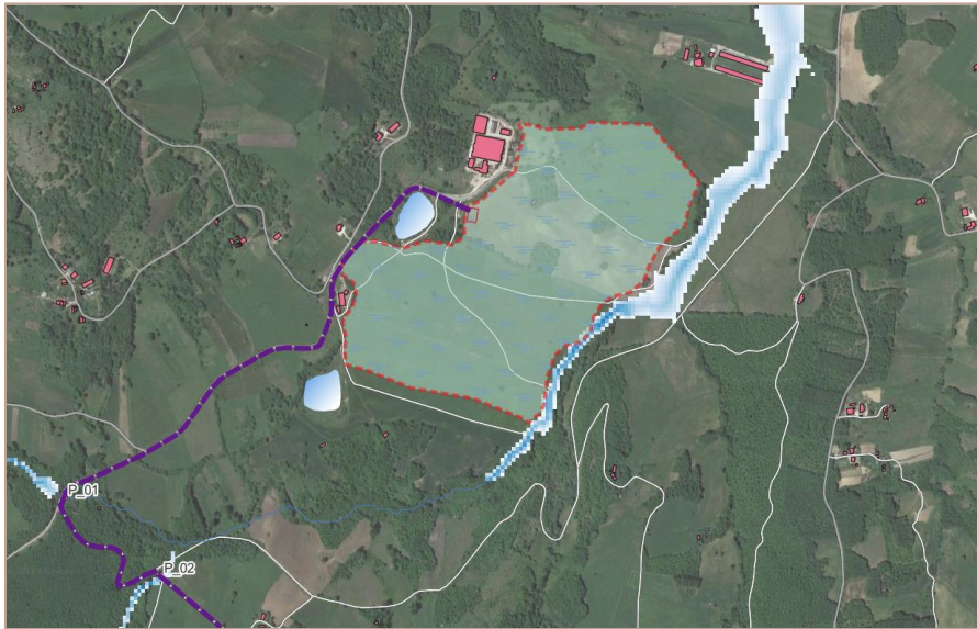
Fig. 11 - Estratto planimetrico della zona di impianto con le aree esondabili per il tempo di ritorno di 30 anni
