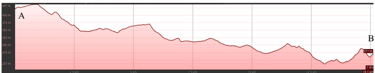
Fig 2.11 – Profilo altimetrico lungo il tracciato del cavidotto
