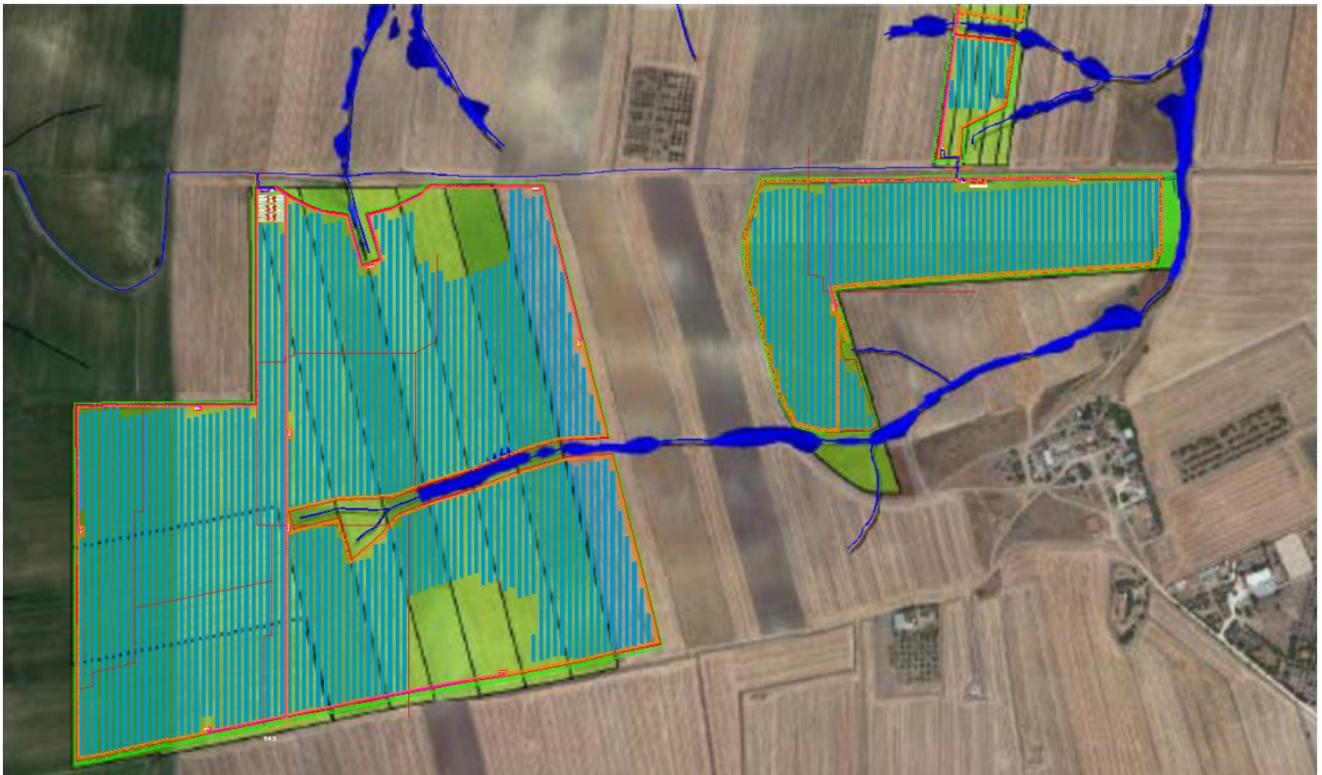
*Fig. 8.1 a – Dettaglio delle aree occupate dai pannelli fotovoltaici; in blu le aree di esondazione per Tr 200 anni*
