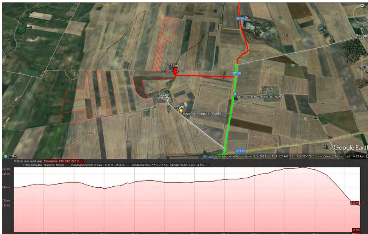
Il profilo elevazione è indicato lungo la linea rossa dall'incrocio SP109 alle aree di progetto
