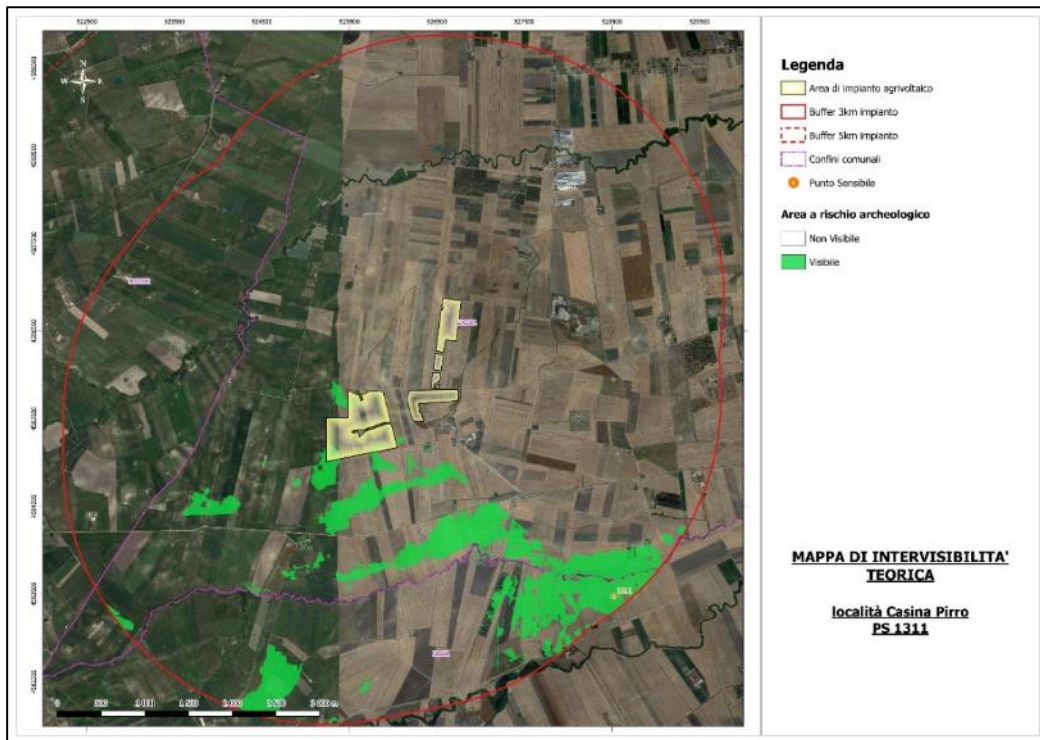
Mappa di Intervisibilità Teorica dai Siti Storico Culturali nell'Area di 3 Km. dal perimetro dell'impianto Osservatore 1311 posto in località Casina Pirro (h. 1,75 m.) – IMPIANTO VISIBILE
