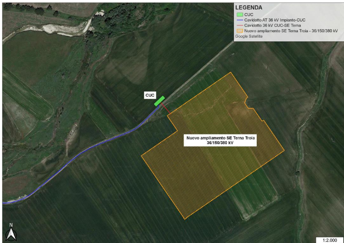
Inquadramento Cabina Utente di Consegna (CUC) su ortofoto, limitrofa all'Ampliamento SE Terna di Troia
