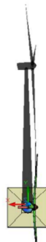
Fig. 2.2 – Proiezione dell'ombra indotta dall'aerogeneratore con rotore in linea con il sole ed il recettore
