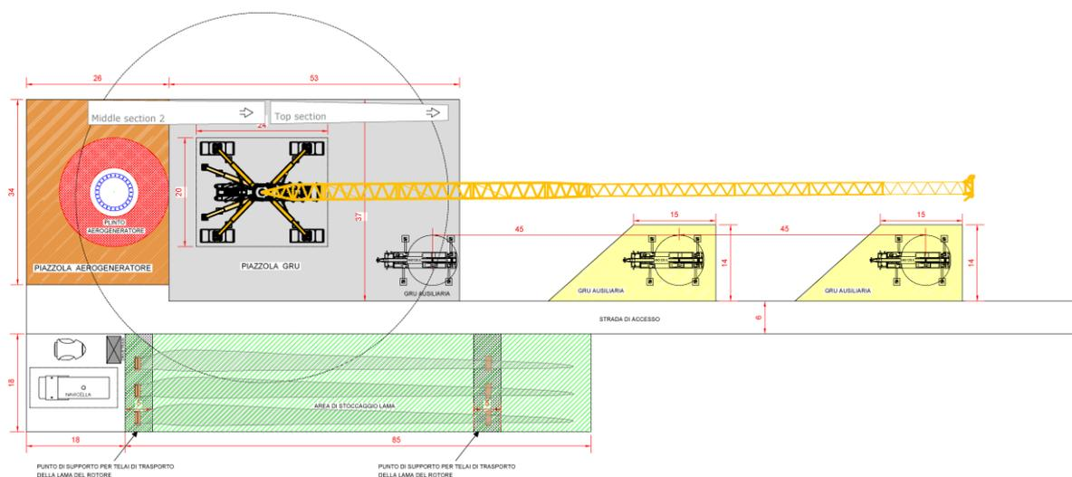
L'occupazione permanente consiste nella realizzazione della piazzola permanente dove verrà installato l'aerogeneratore avente una dimensione di  $34 \times 26 = 884$  mq.
