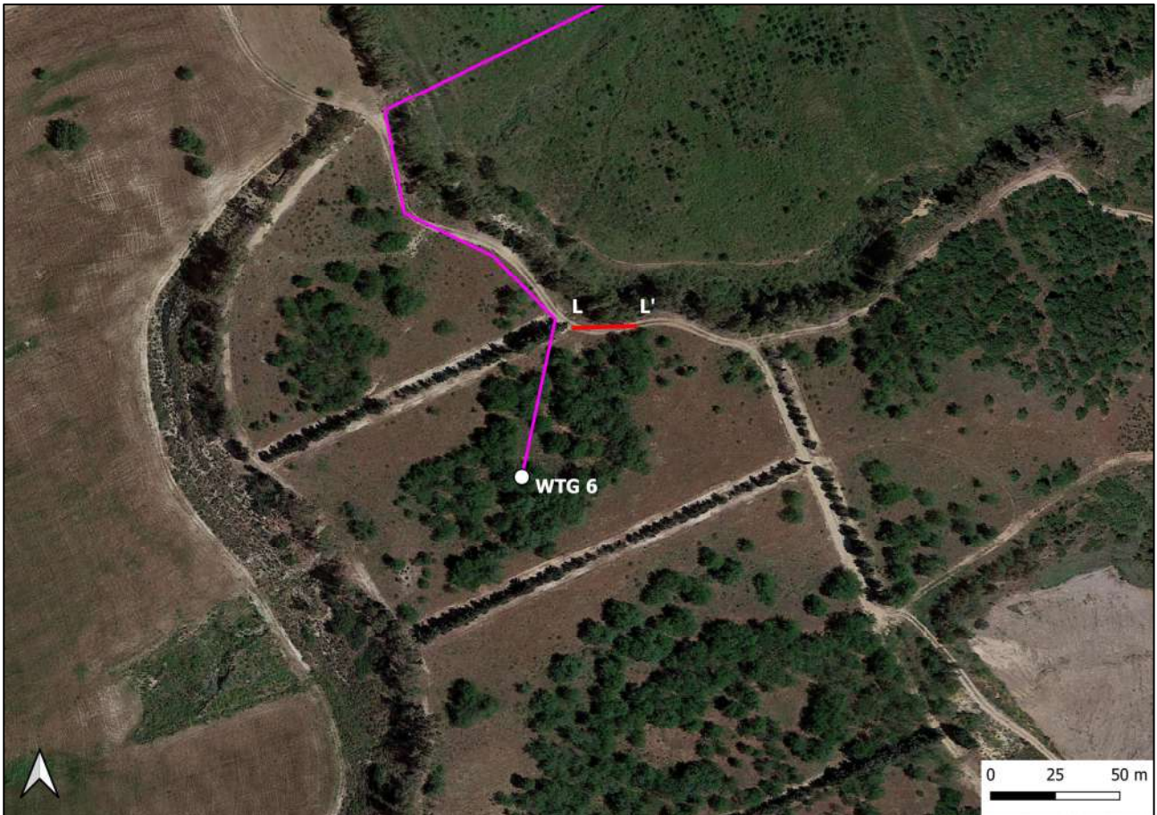
Fig. 12 – Ubicazione dello stendimento sismico LL' su Ortofoto
