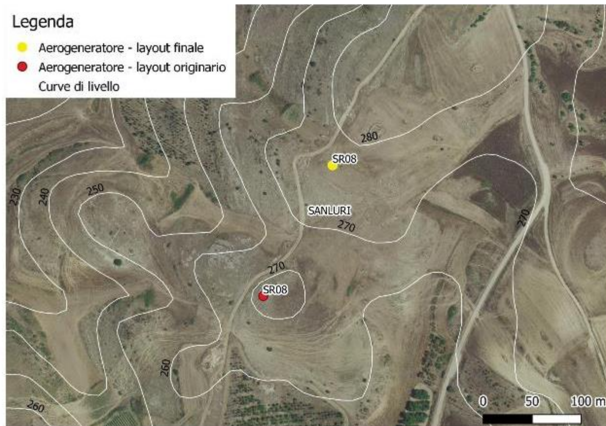
Figura 9.1 Evoluzione del layout originario (rosso) e layout di progetto (giallo), postazione SR08
