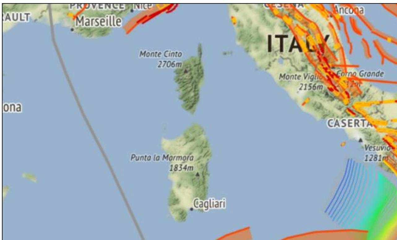
Figura 10.94: Localizzazione delle potenziali sorgenti di terremoti con M > 5,5 rispetto all'area di intervento (estratto da DISS Working group 2018, Database of Individual Seismogenic Sources ver. 3.2.1., http://diss.rm.ingv.it/dissmap/dissmap.phtml ).
