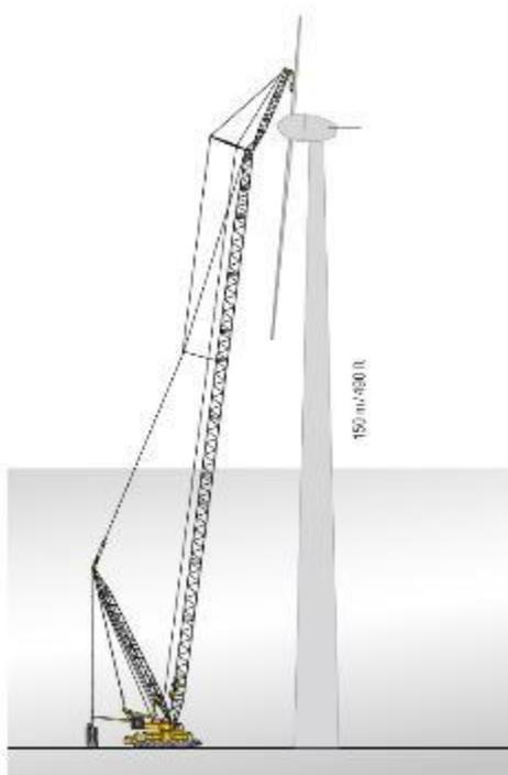
Figura 5.32 – Schema di una gru cingolata a traliccio con sistema derrick impiegata per l'innalzamento delle turbine eoliche dell'ultima generazione
