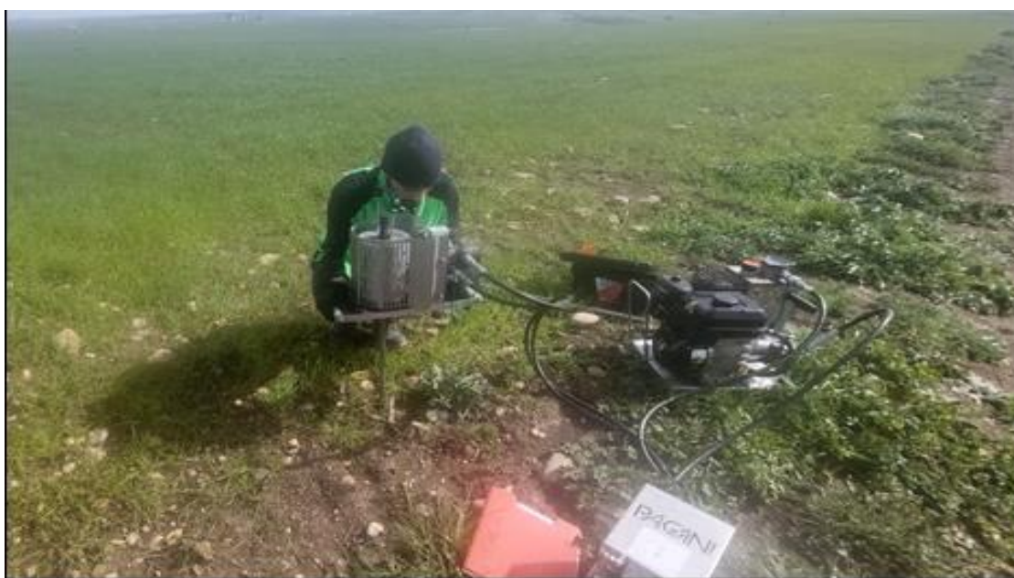
PROVE PENETROMETRICHE ESEGUITE P1, P2, P3
