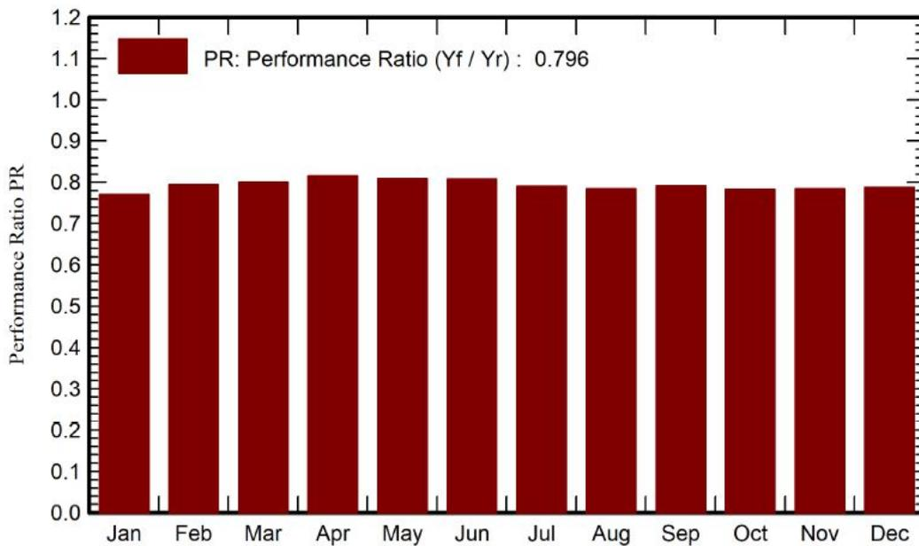
Figura 2 Produzione normalizzata (per KW installato): Potenza nominale 19995 kWp
