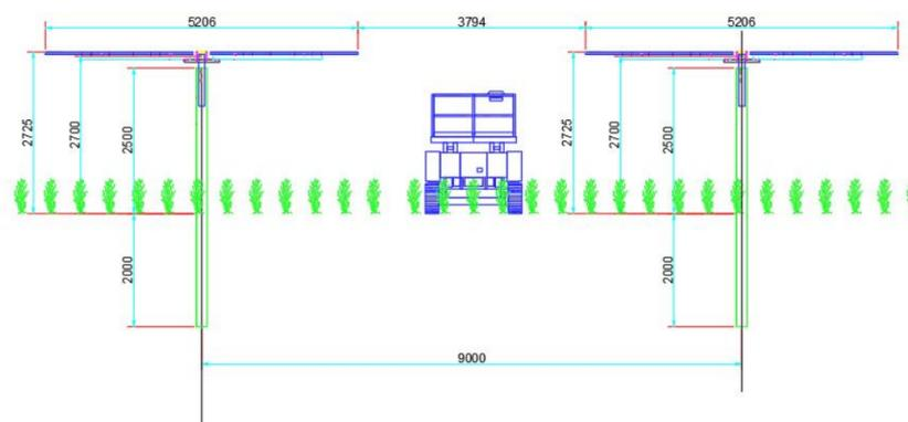
Tracker - Configurazione orizzontale - Sezione laterale
