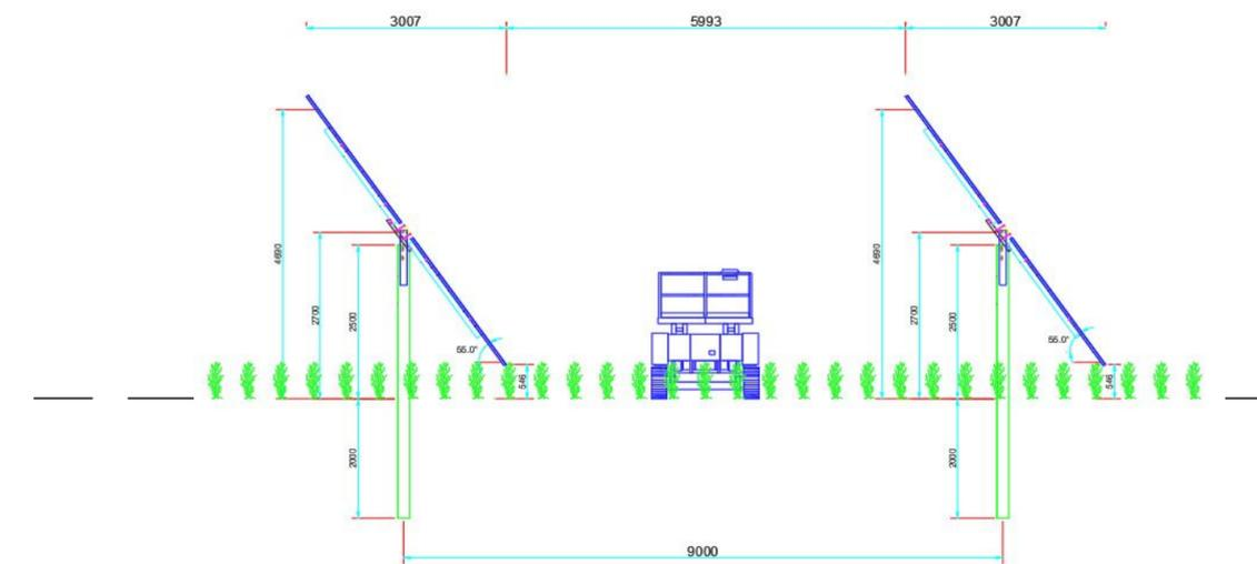
Tracker - Configurazione massima rotazione - Sezione laterale
