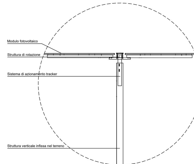
Tracker - Sezione di dettaglio
