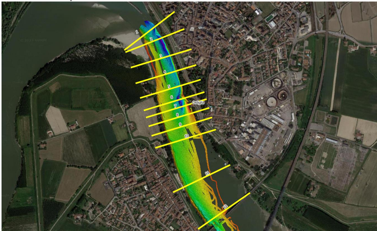
Immagine 13: Batimetria effettuata in prossimità dell'opera di Ostiglia con indicazione di alcune sezioni di studio.
