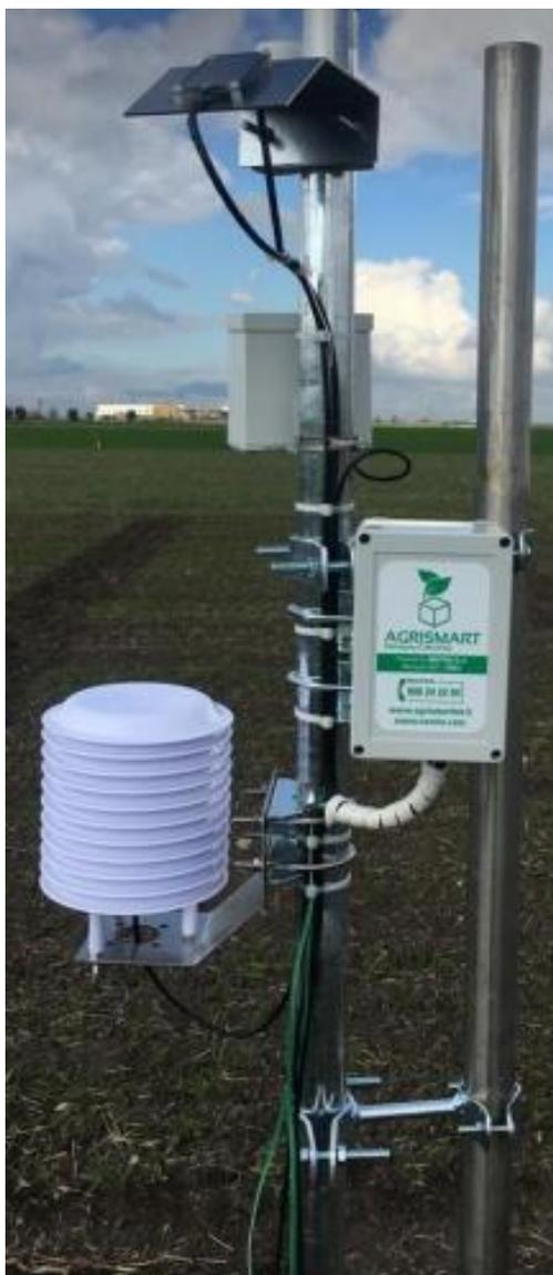
Figura 26 - Stazione meteo AGRISMART IOT
