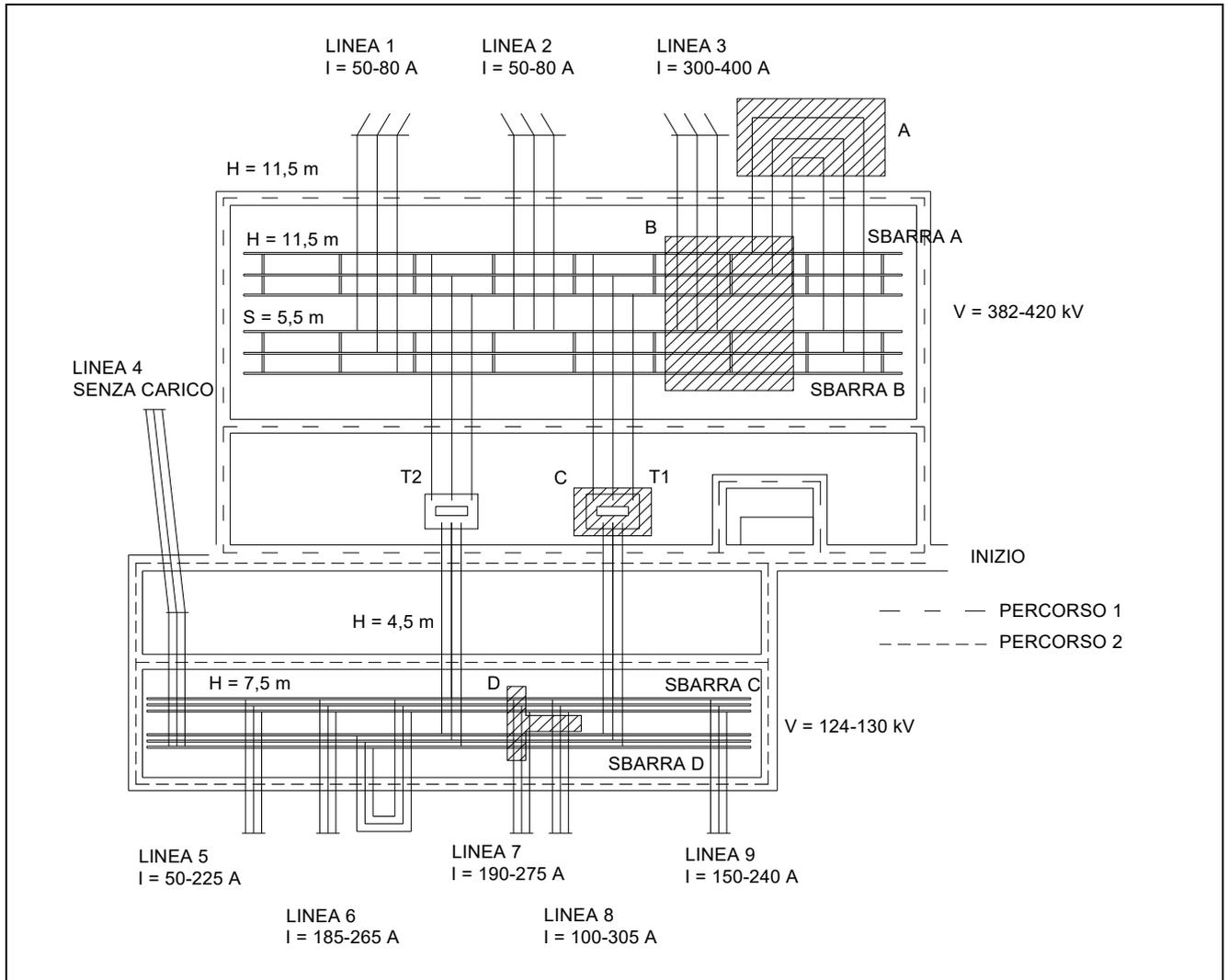
**Fig. 1** – Pianta di una tipica stazione 380/132 kV con l'indicazione delle principali distanze fase-fase (S) e fase-terra (H) e delle variazioni delle tensioni e delle correnti durante la fasi di misurazioni di campo elettrico e magnetico.
