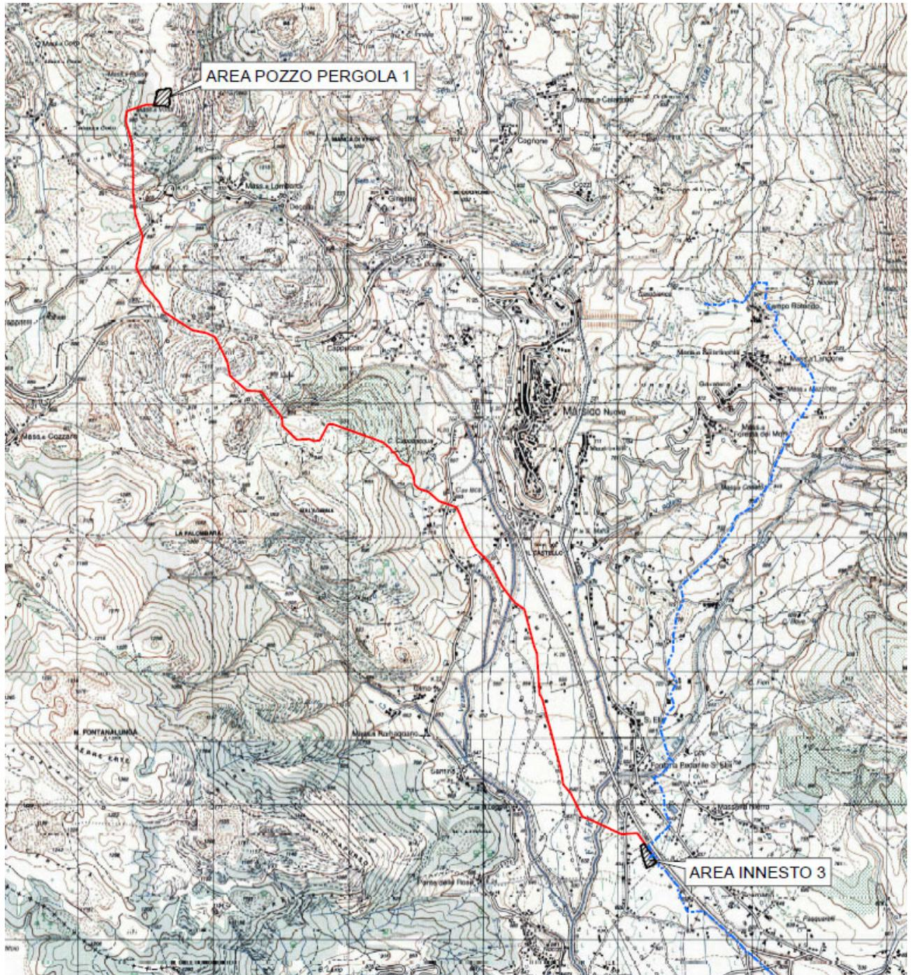
Figura 2-2: Stralcio planimetrico carta IGM con indicazione del tracciato in progetto (in rosso) delle condotte.
