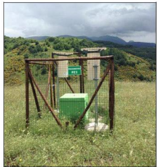
Figura 6.5: Esempi di posizionamento di deposimetri
