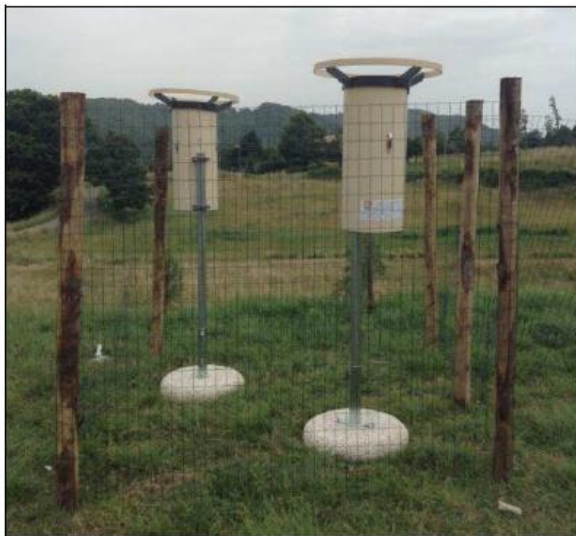
Figura 6.5: Esempi di posizionamento di deposimetri
