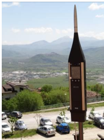
Figura 7.1: Esempio di analizzatore di rumore
