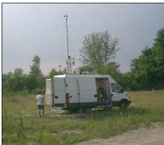
Figura 6.4: Esempi di monitoraggio della qualità dell'aria mediante stazione mobile
