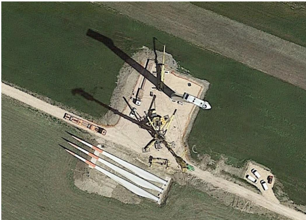
*Figura 2.6 – esempio di piazzola in fase di costruzione*
