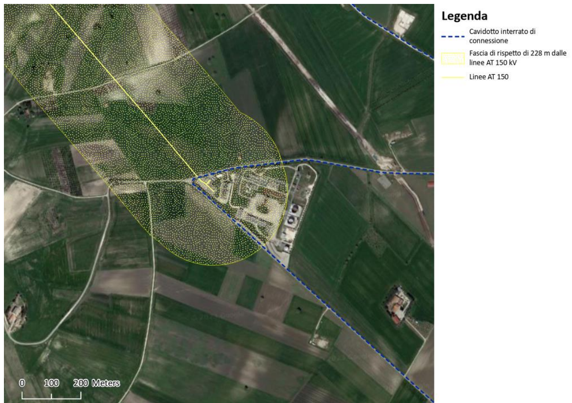
Figura 2.58: Cavidotto interrato di connessione in relazione alle aree di rispetto da linee di alta tensione.
