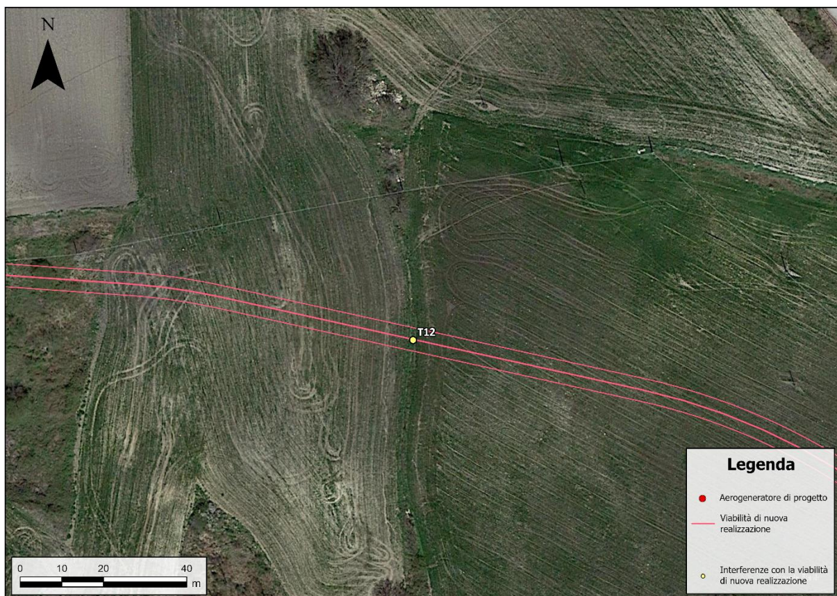
Figura 7.13: Interferenza T12, tra la viabilità di accesso alla torre MU24 e l'idrografia.
