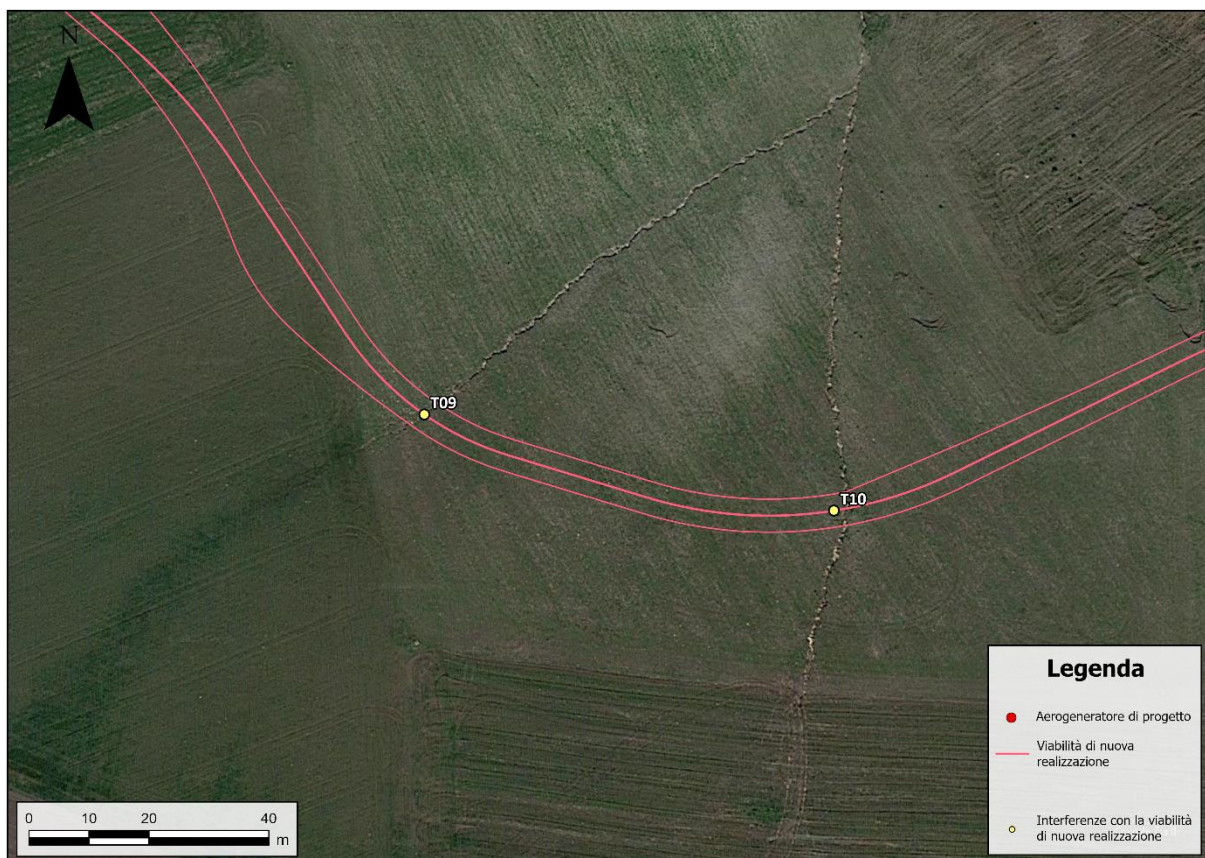
Figura 7.11: Interferenza T10, tra la viabilità di accesso alla torre MU23 e l'idrografia.
