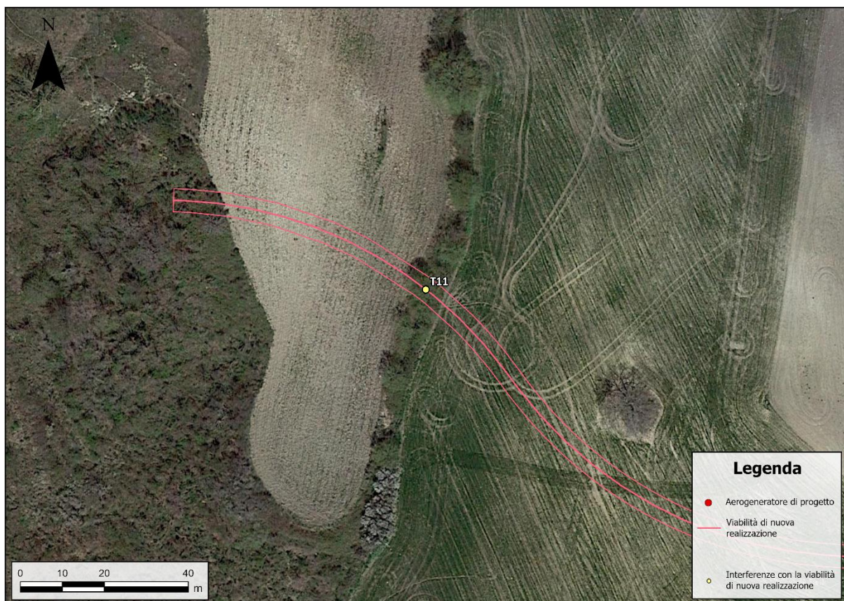
Figura 7.12: Interferenza T11, tra la viabilità di accesso alla torre MU24 e l'idrografia.
