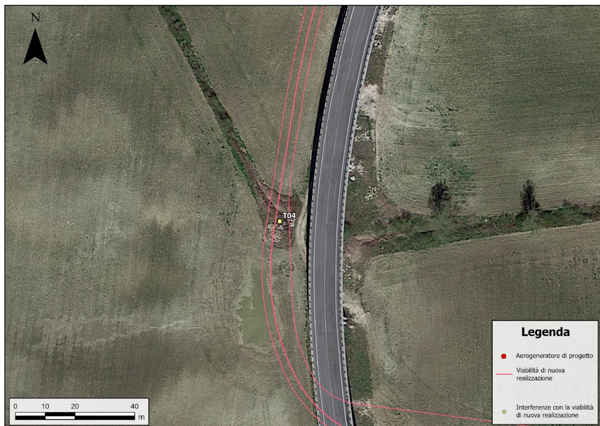
Figura 7.5: Interferenza T04, tra la viabilità di accesso alla torre MU08 e l'idrografia.
