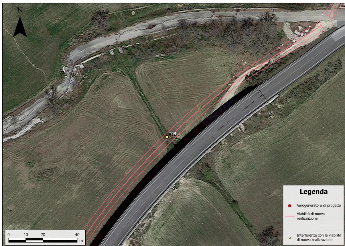
Figura 7.4: Interferenza T03, tra la viabilità di accesso alla torre MU07 e l'idrografia.
