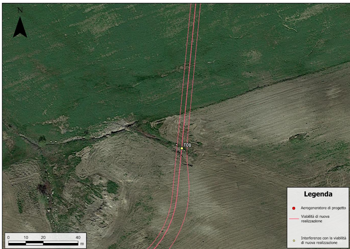
Figura 7.2: Interferenza T01, tra la viabilità di accesso alla torre MU01 e l'idrografia.
