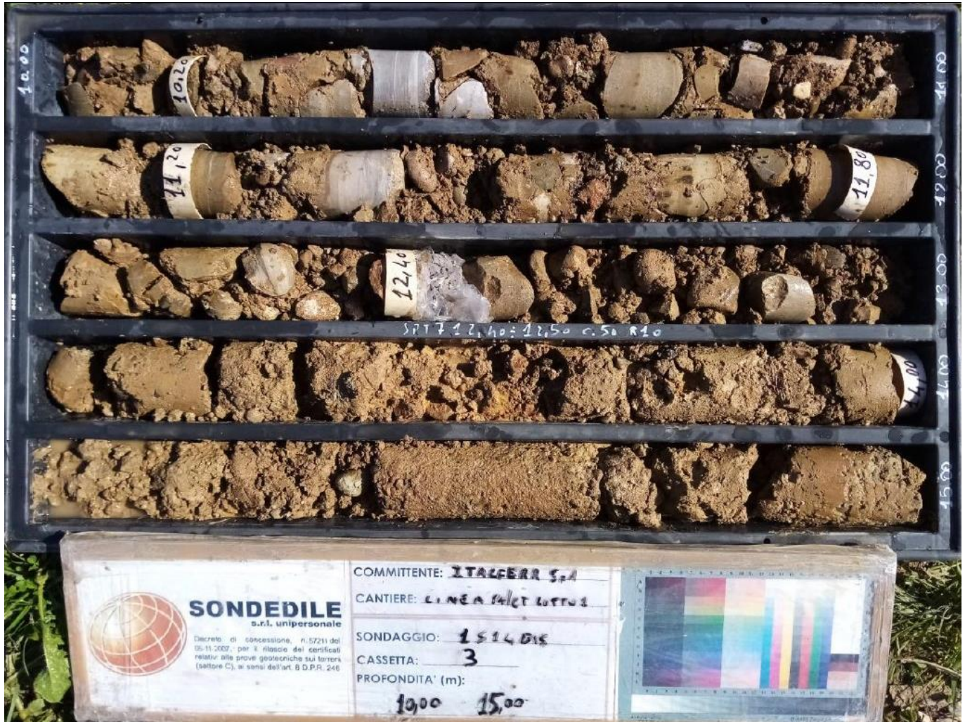
Foto 2 – Litofacies ghiaioso-sabbiosa dei Depositi alluvionali recenti (bb2) nel foro di sondaggio 1S14bis, tra 10.0 e 15.0 m dal p.c..
