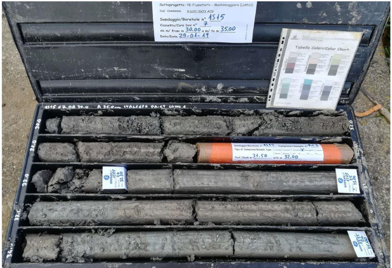
Foto 1 - Litofacies argilloso-marnosa delle Argille Varicolori Inferiori (AVF) nel foro di sondaggio 1S15, tra 30.0 e 35.0 m dal p.c..
