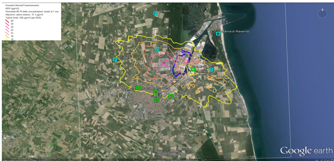
Figura 3.9-A – Isolivelli del percentile 99.79 delle concentrazioni medie di 1 ora di NOx. Scenario AO/PO di Normale Funzionamento
