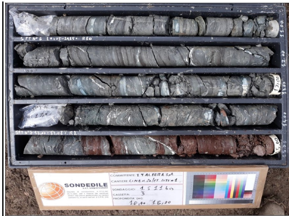
Figura 57 – Foto cassetta 1S11bis (da 10.0 a 15.0 m) – AVF argillite
