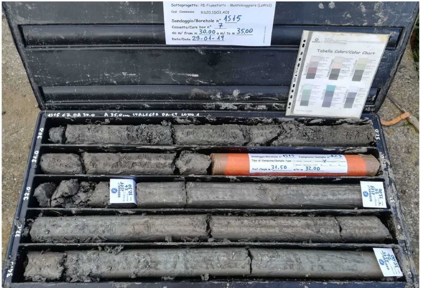
Figura 2 – Litofacies argilloso-marnosa delle Argille Varicolori Inferiori (AVF) - sondaggio 1S15 cassetta tra 30.0 e 35.0 m
