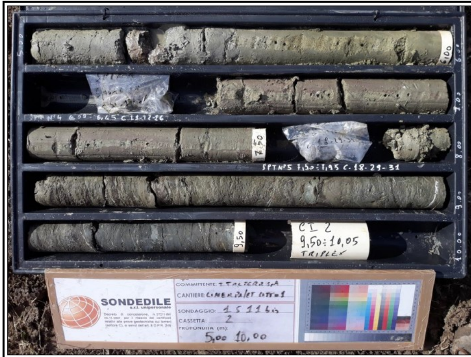
Figura 54 – Foto cassetta 1S11bis (da 5.0 a 10.0 m) – AVF argilla marnosa
