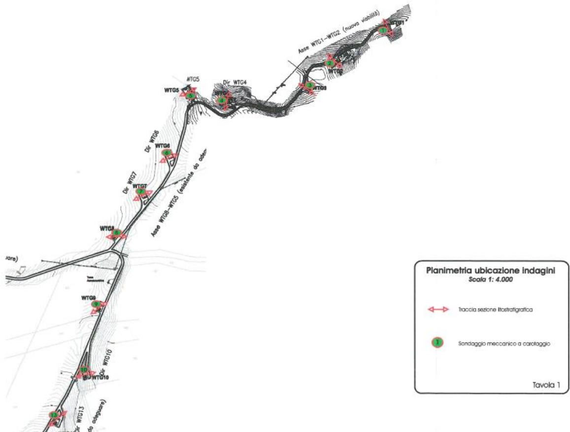
Figura 3-1 - Campagna di indagini del 2005 per la progettazione del campo eolico esistente. Ubicazione dei sondaggi da CV 1 - 1 a CV 1 - 14
